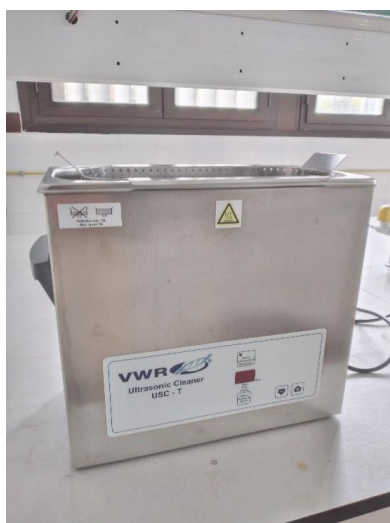
Figura 10.- Baño de ultrasonidos. Foto: Elaboración propia.
