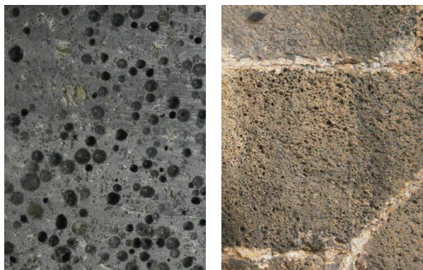
Figuras 51-52.- Basalto olivínico vacuolar (izda. imagen CM, dcha. Imagen VP).
