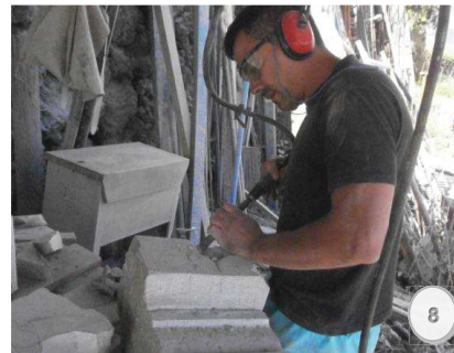
Figura 8.- Desbaste del frente del ábaco.
