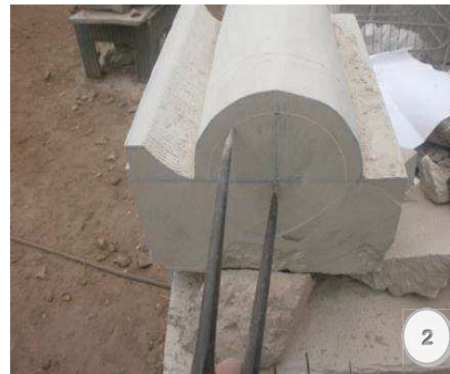
Figura 2.- Trazado de los costados del diámetro total del baquetón.
