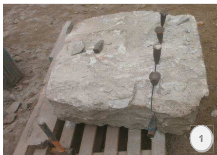
Figura 1.- Bloque de piedra seleccionado. Línea de corte y disposición de las cuñas.
