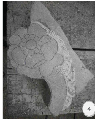
Figura 4.- Recorte interior del motivo y fondeado.
