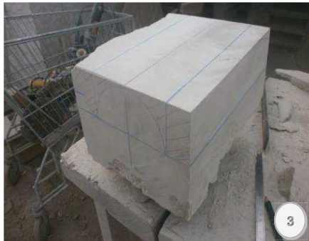
Figura 3.- Vista general del tazado del bloque y selección con líneas de color rojo del material a eliminar.
