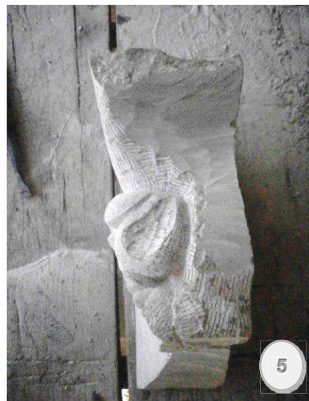
Figura 5.- Encajado y recorteado de la parte exterior del motivo.
