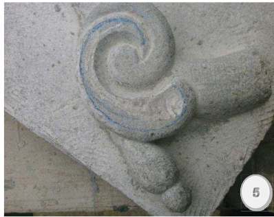
Figura 5.- Ahuecado del interior y redondeado exterior de la hoja.
