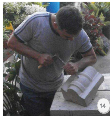
Figura 14.- Marcado general mediante la gradina.
