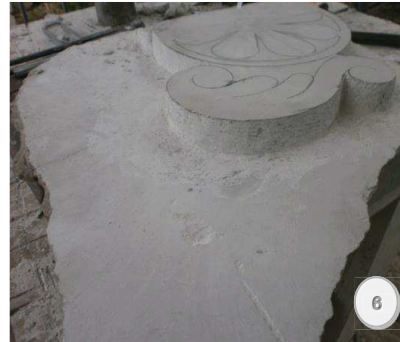
Figura 6.- Vista lateral del recorte y fondeado del motivo ornamental.
