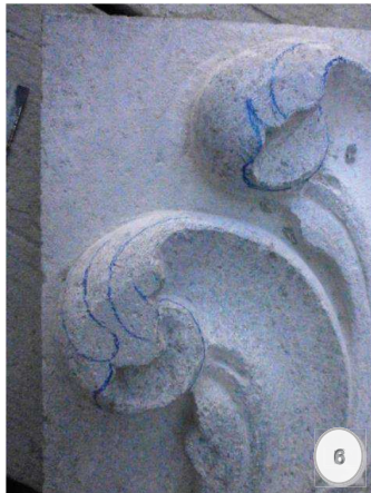
Figura 6.- Traza de las hojas que componen las cabezas cerradas.
