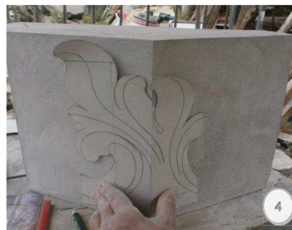
Figura 4.- Transferencia de la plantilla a la piedra.
