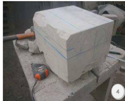
Figura 4.- Vista general del tazado del bloque y selección con líneas de color rojo del material a eliminar.
