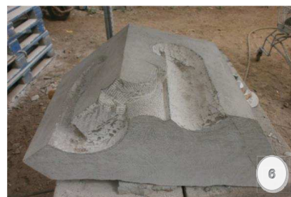
Figura 6.- Segundo desbaste, perfilado de las molduras y recorte del adorno central.
