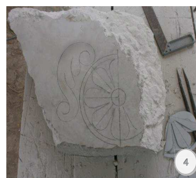
Figura 4.- Muestra de la transferencia del dibujo a a la piedra.
