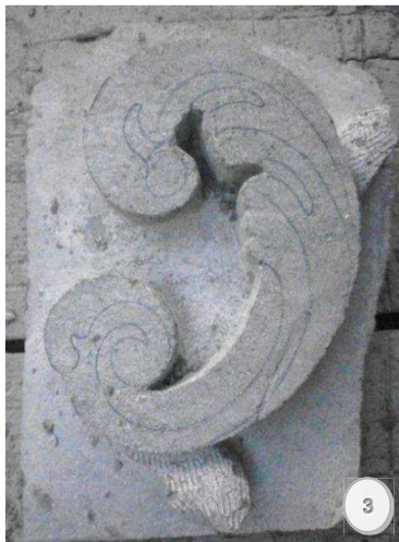
Figura 3.-Labra y encajado de los adornos exteriores de la composición.
