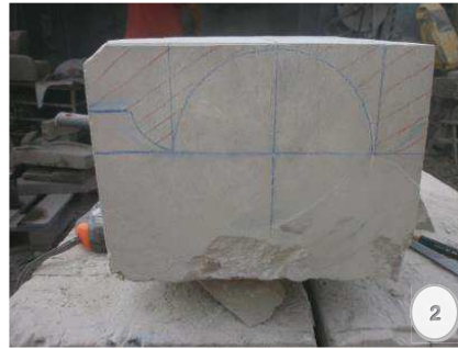
Figura 2.- Trazado en diagonal con líneas de color rojo, corresponde con material que hay que eliminar.
