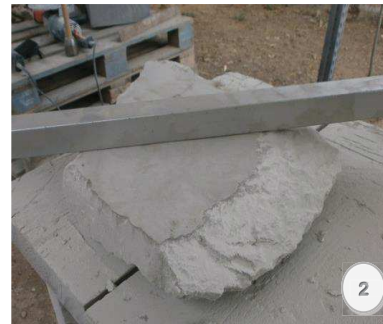
Figura 2.- Superficie plana de trabajo. Se comprueba con una regla que no existen alabeos.
