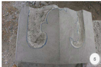
Figura 5.- Primer desbaste y encajado de las diferentes formas de la composición.
