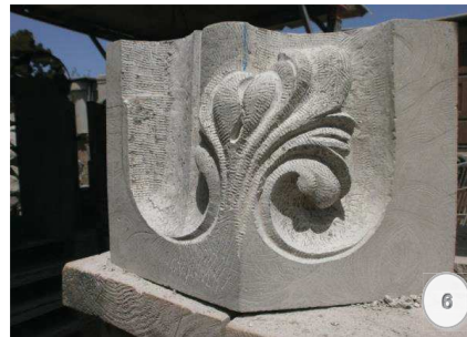
Figura 6.- Acabado superficial mediante cinceles y gubias.
