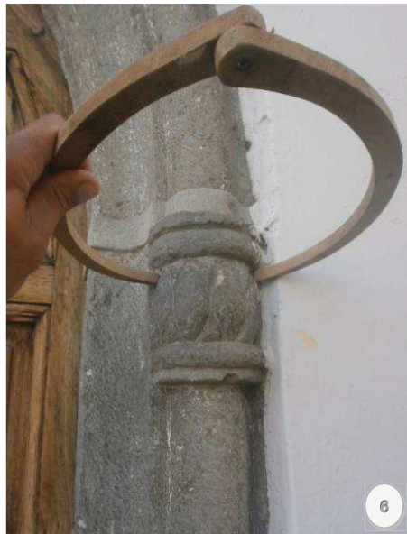
Figura 6.- Toma de la medida de los diferentes diámetros del capitel.
