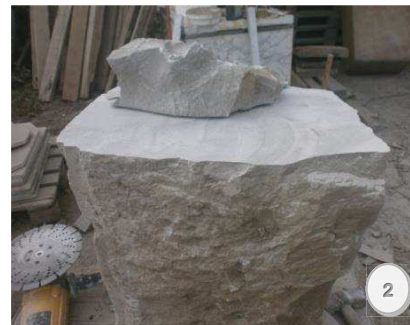
Figura 2.- Labrado de la primera superficie plana (primer paramento).
