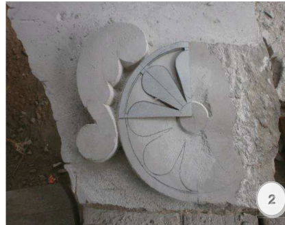
Figura 2.-.- Transferencia de la plantilla a la piedra.
