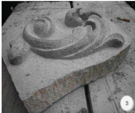
Figura 3.- Vista lateral del motivo, repasado con gradina.
