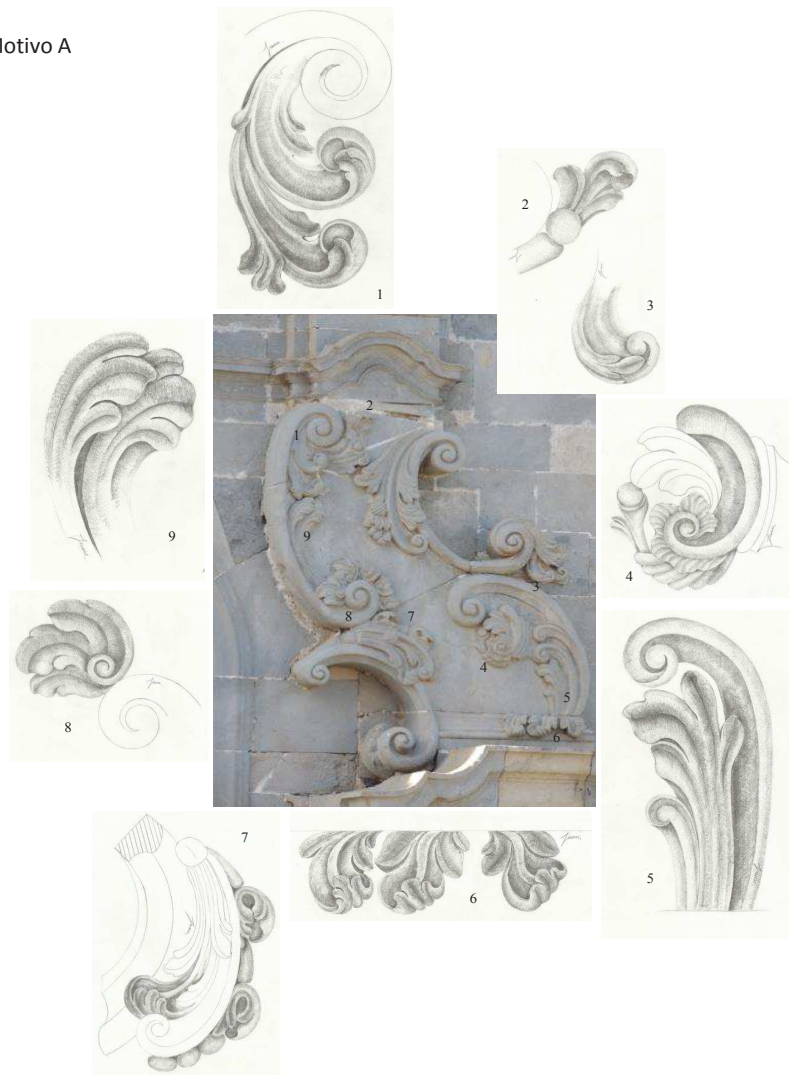
Figura 13.- Esquema de diseño de los elementos ornamentales que componen el motivo en forma de sierpe, ubicado en el lateral derecho enlazando con el basamento de la columna derecha del segundo cuerpo y disposición de volúmenes/claroscuros.
