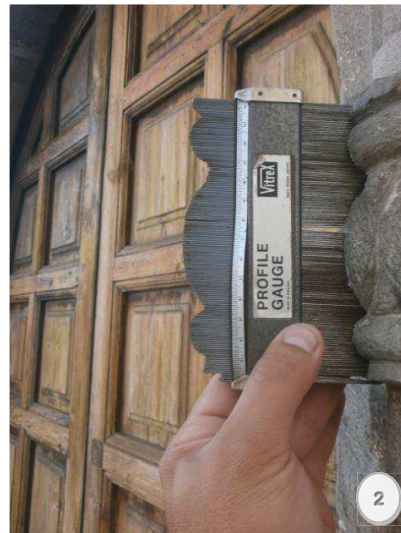
Figura 2.- Utilización del captador de curvas para obtención de las formas del contorno del capitel.
