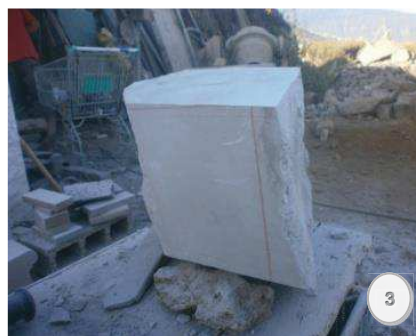
Figura 3.- Labrado del primer y segundo paramento.
