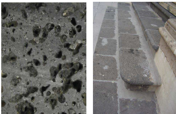
Figuras 11-12.- Basalto olivínico piroxénico vacuolar (izda. imagen CM, dcha. Imagen VP).
