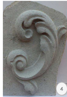
Figura 4.- Acabado superficial mediante cincelos y gubias.
