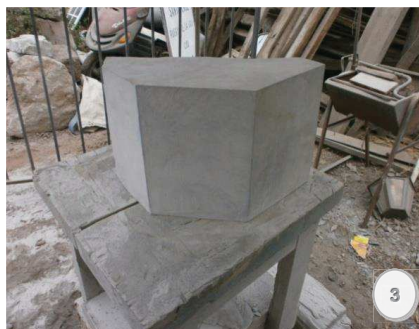
Figura 3.- Labrado de los cinco paramentos del bloque y a escuadra de todas sus caras.
