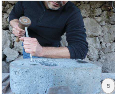
Figura 5.- Desbaste interior (calado).
