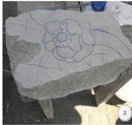
Figura 2.- Vista del trazado del motivo y selección con marcas en cruz de color rojo del material a eliminar.
