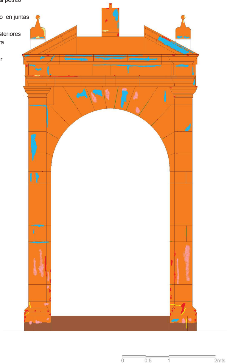
Figura 4.- Cartografía de daños de la portada de la iglesia de San Juan Bautista del Farrobo. Realizada en 2013.
