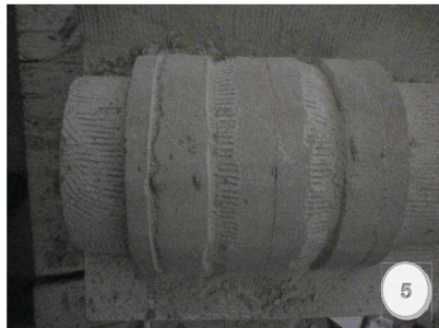
Figura 5.- Desbaste inicial con gradina de los anillos anulares, cuadras y volumen esférico.
