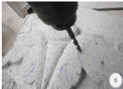
Figura 5.- En la intersección del nacimiento de las hojas se realiza un trepano.
