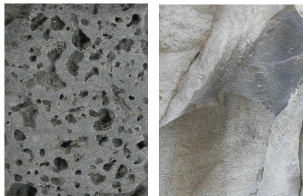
Figuras 107-108.- Traquibasalto (izda. imagen CM, dcha. Imagen FC).
