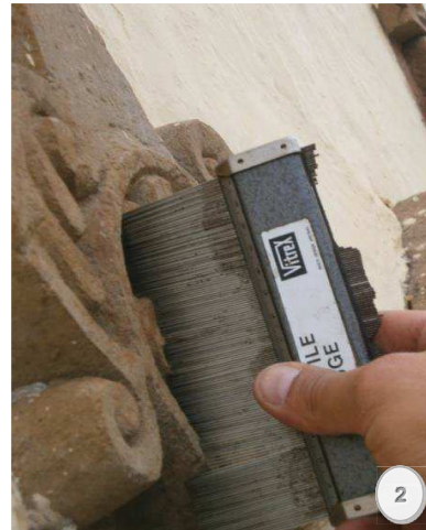
Figura 2.- Medición de la sección de profundidad.
