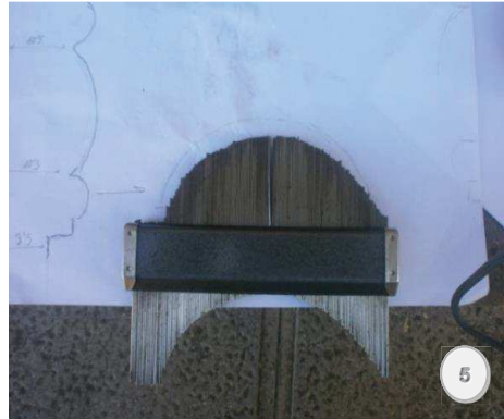
Figura 5.- Traspaso de las medidas tomadas a papel.
