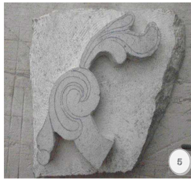
Figura 5.- Vista frontal del recorte y fondeado del motivo ornamental.
