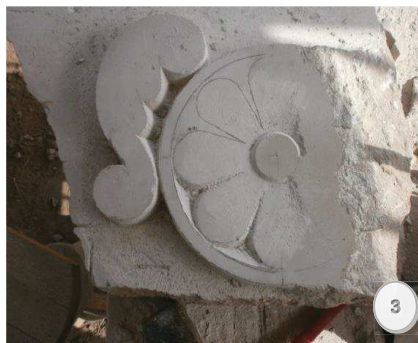
Figura 3.- Desbaste inicial de los contornos de los pétalos.
