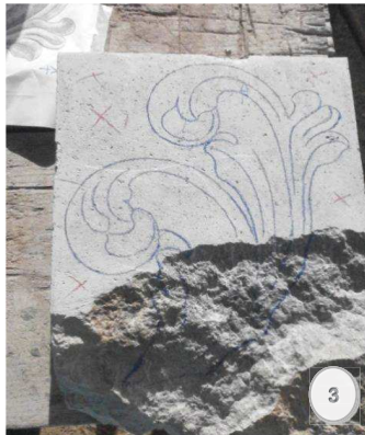
Figura 3.- Superficie con marcas en cruz de color rojo del material a eliminar.
