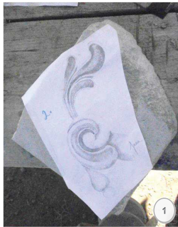
Figura 1.- Bloque de piedra seleccionado con superficie plana realizada y plantilla.
