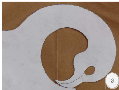
Figura 3.- Plantilla para las transferencias de las medidas a la piedra
