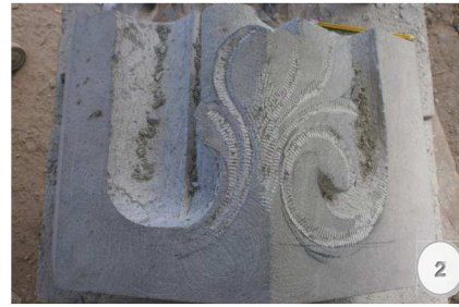
Figura 2.- Profundizado de los nervios de las hojas.
