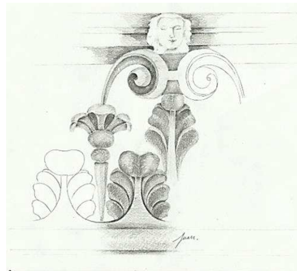
Figura 6.- Esquema de diseño de los capiteles de las pilastras del primer cuerpo y disposición de volúmenes/claroscuros.
