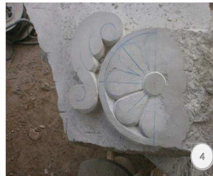
Figura 4.- Acabado superficial de los contornos de los pétalos con gubia.
