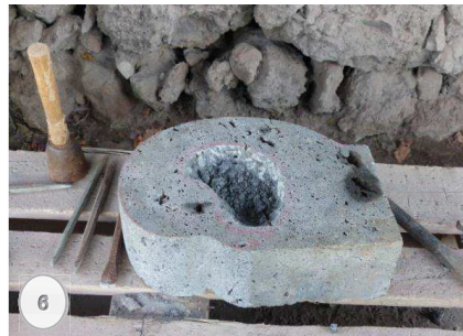
Figura 6.- Desbaste interior (calado).
