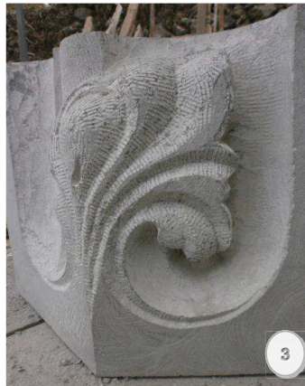
Figura 3.- Modelado de las formas con gradina.
