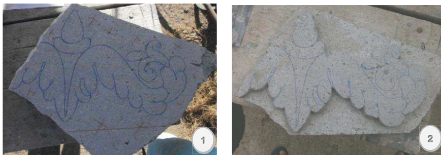
Figura 1.- Vista del trazado del motivo y selección con marcas en cruz de color rojo del material a eliminar.
