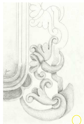
Figura 12.- Esquema de diseño de los motivos vegetales del primer tercio de los fustes de las columnas y disposición de volúmenes/claroscuros.
