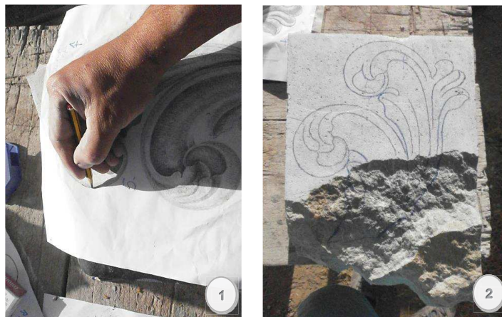
Figura 1.- Transferencia del dibujo a la piedra mediante papel de calco.
