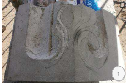
Figura 1.- Profundizado de los nervios de las hojas.
