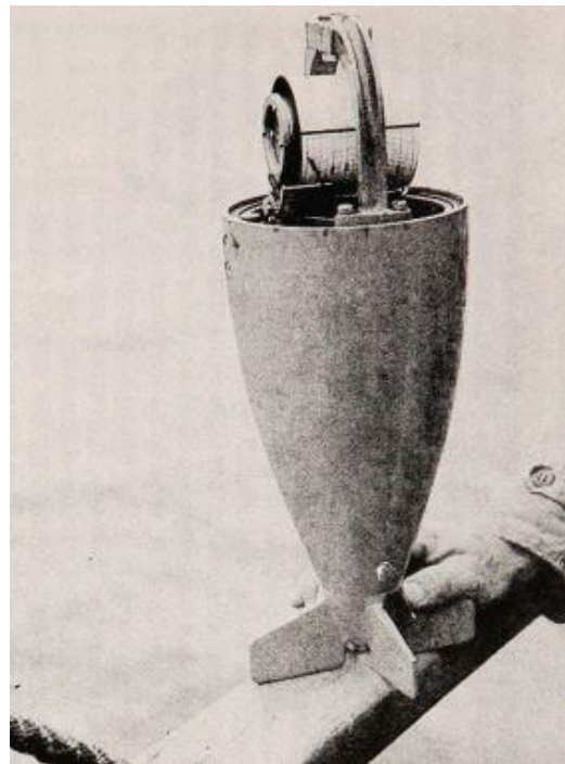
Figura 3 y 4. A la izquierda, red con registrador de profundidad en la parte superior y plomos en la parte inferior para hundirla. A la derecha, registrador de profundidad (Tucker, 1951).
