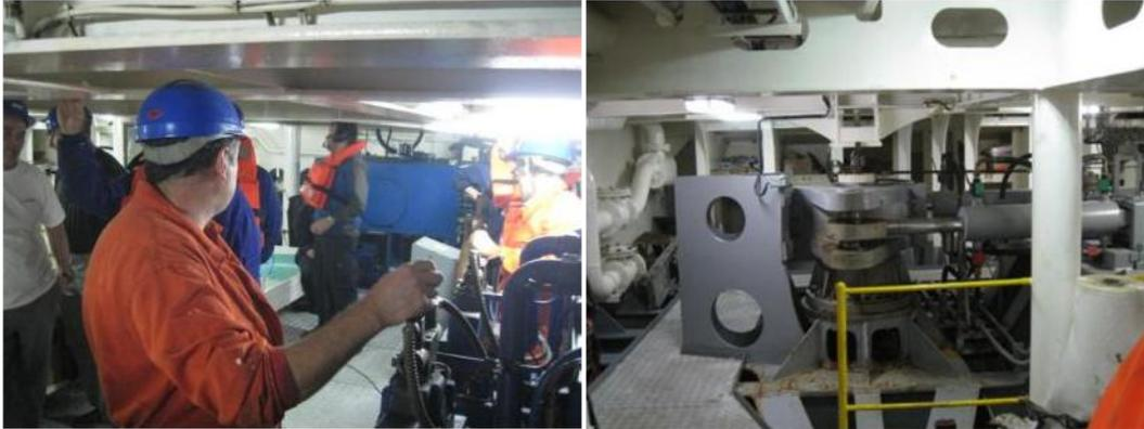
Ilustración 10. Local del servomotor durante un ejercicio de fallo en el sistema de gobierno. Fuente: Elaboración propia.
