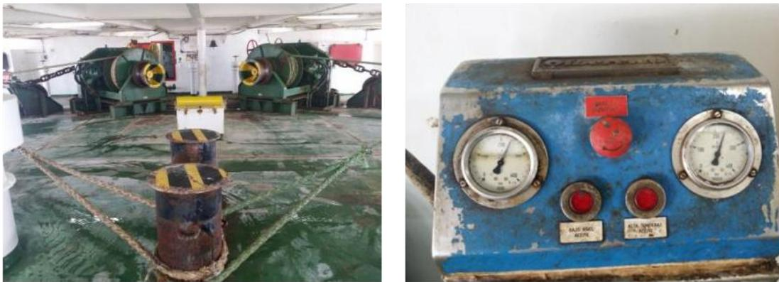
Ilustración 12. Maquinillas y molinetes de proa durante una prueba de presión. Fuente: Elaboración propia.
