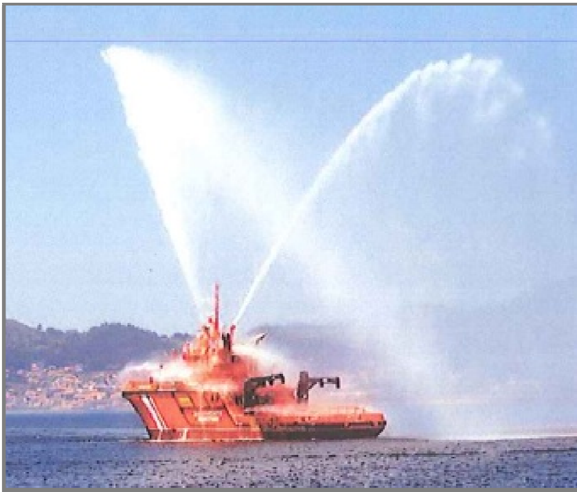
Imagen n°29: Sistema contra incendios en funcionamiento.
