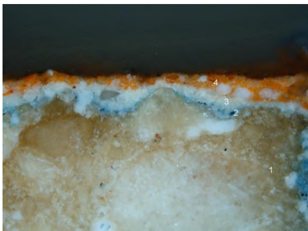
Fig. 62. Imagen obtenida al microscopio óptico de la sección transversal de la micromuestra Nº 3 (objetivo MPlan 10X/0,30). El orden numérico que se indica es el que aparece en la tabla correspondiente.
