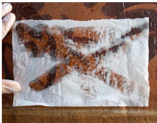
Fig.74. Inicio de la aplicación del gel y el papel tisú.
