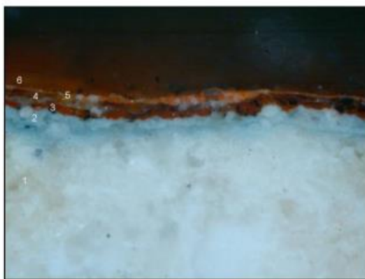
Figura 2.- Imagen obtenida al microscopio óptico de la sección transversal de la micromuestra N° 2 (objetivo MPlan 10X/0,30). El orden numérico que se indica es el que aparece en la tabla correspondiente
