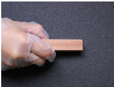
Fig.115. Redimensión de cuña de madera de tea con una lija.
