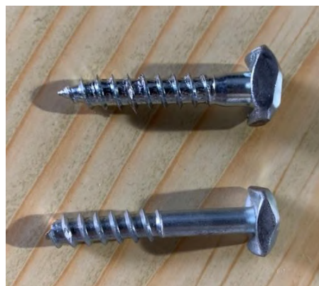
Fig.155. Detalle de los tornillos. Tornillo superior normal y tornillo inferior de seguridad.
