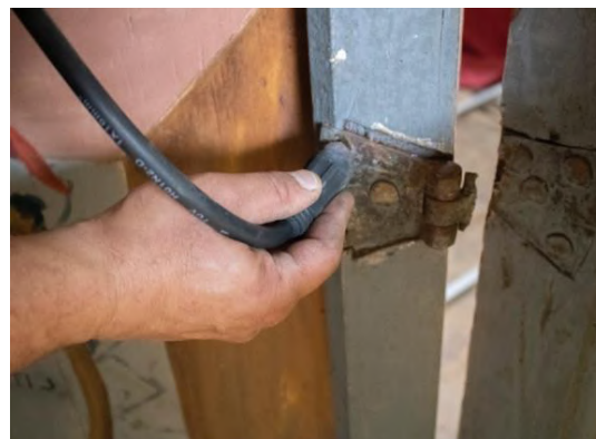
Fig.102. Ubicación de un electrodo negativo en el reverso de la puerta sobre un clavo.
