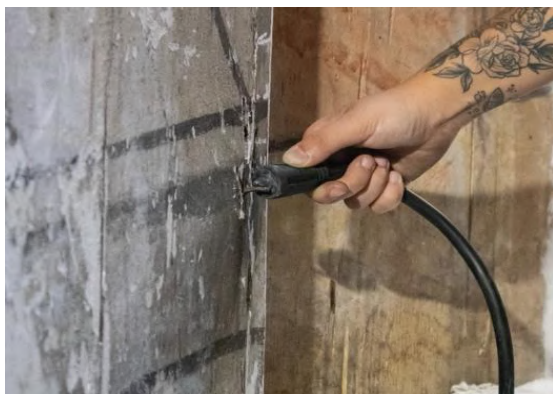
Fig.101. Ubicación de un electrodo positivo en el anverso de la puerta sobre un clavo.
