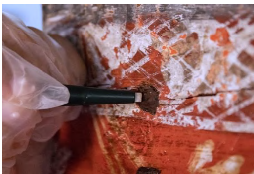
Fig.95. Limpieza de un clavo con un lápiz de fibra de vidrio.
