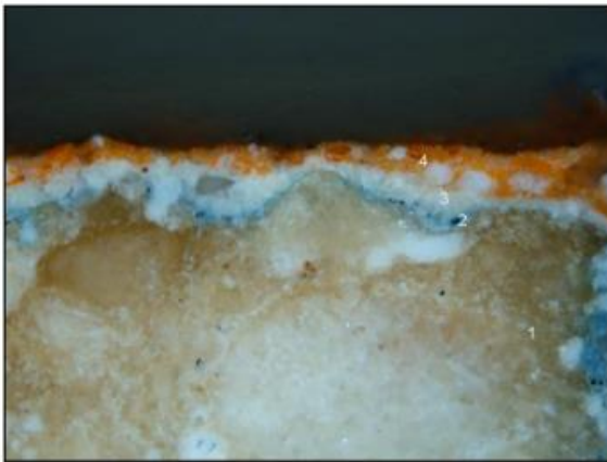
Figura 3.- Imagen obtenida al microscopio óptico de la sección transversal de la micromuestra N° 3 (objetivo MPlan 10X/0,30). El orden numérico que se indica es el que aparece en la tabla correspondiente
