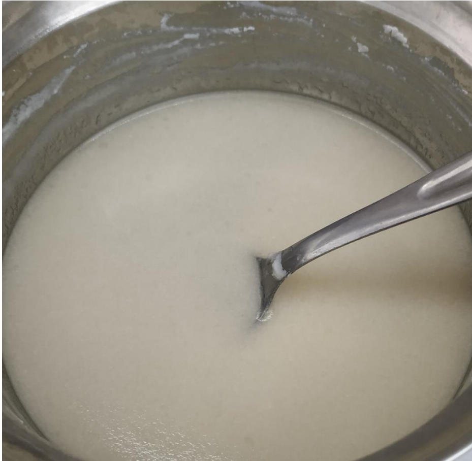
Figura 133: cera saponificada tras agregar amoníaco.
