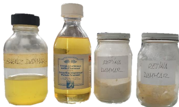
Figura 106: desde la izquierda, barniz dammar casero, barniz dammar comprado, resina dammar en polvo, resina dammar.
