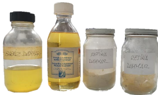
Figura 25: desde la izquierda, barniz dammar casero, barniz dammar comprado, resina dammar en polvo, resina dammar.
