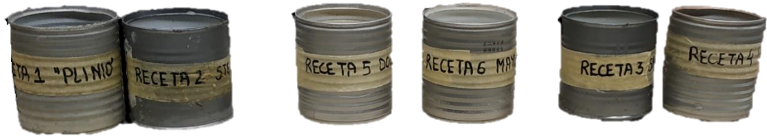
Figura 156: desde la izquierda, recetas de cera en caliente, recetas de cera saponificada y recetas de cera en frío.
