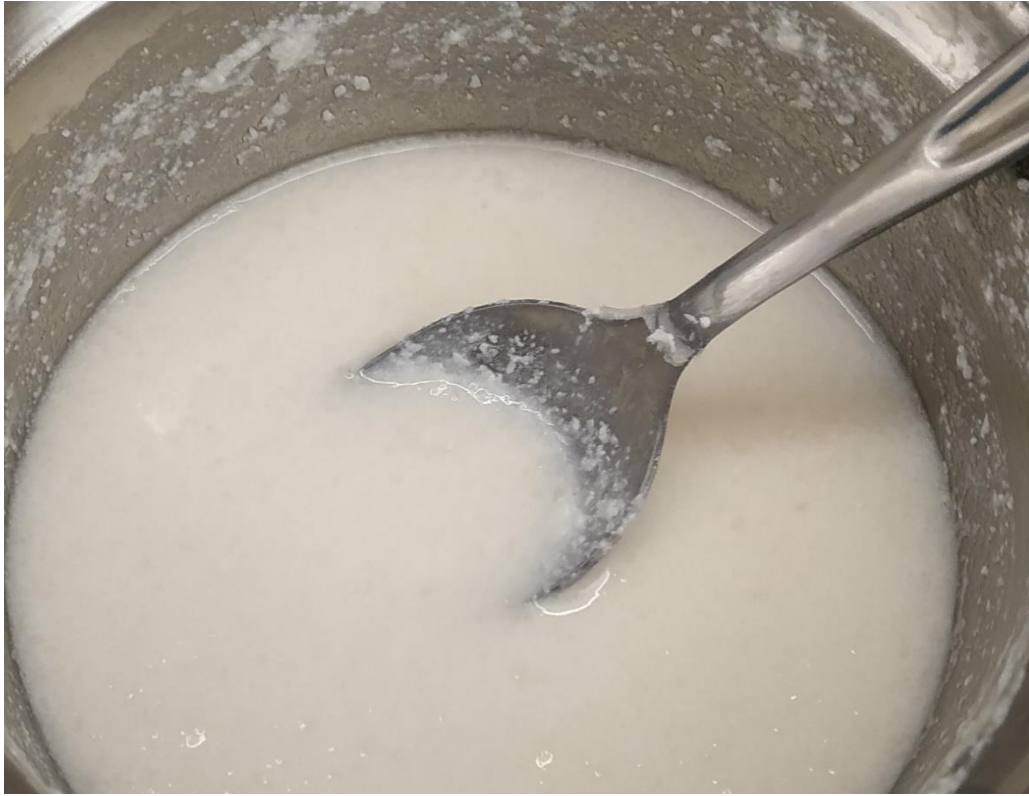
Figura 147: cera saponificada tras agregar carbonato de amonio.
