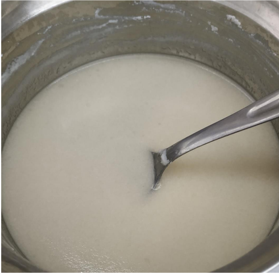
Figura 52: cera saponificada tras agregar amoníaco.
