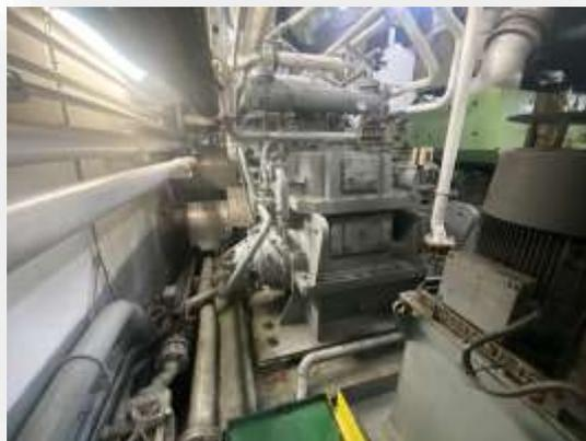
**Ilustración nº15.** Reductora motores principales
