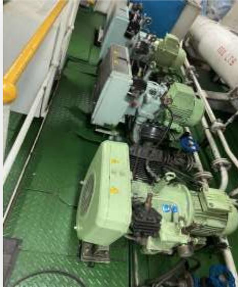
**Ilustración n°43.** Compresores de aire de arranque
