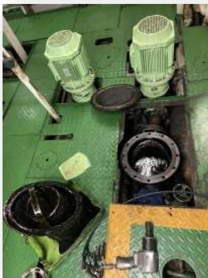
**Ilustración nº67.** Filtro de la bomba de trasiego de fuel
