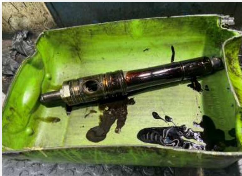
**Ilustración nº56.** Inyector del sistema de combustible
