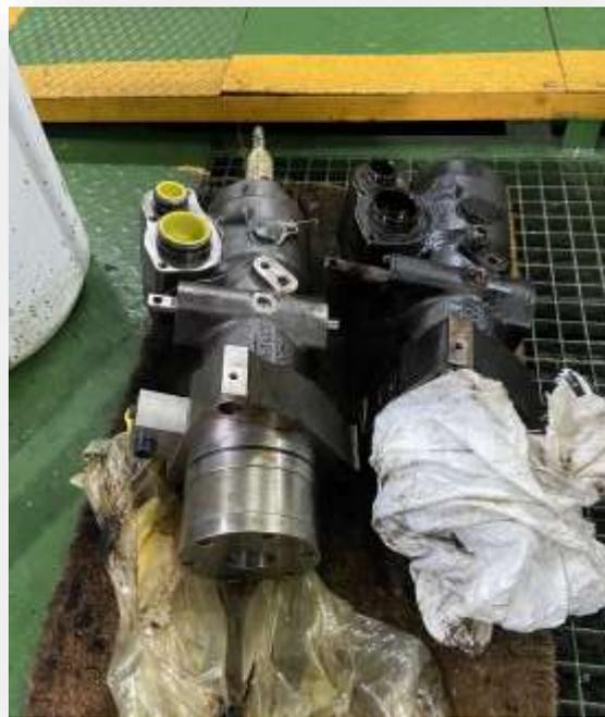
**Ilustración nº57.** Bomba de inyección del sistema de combustible
