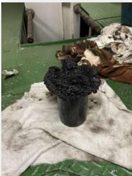
**Ilustración nº73.** Filtro de la bomba de lodos
