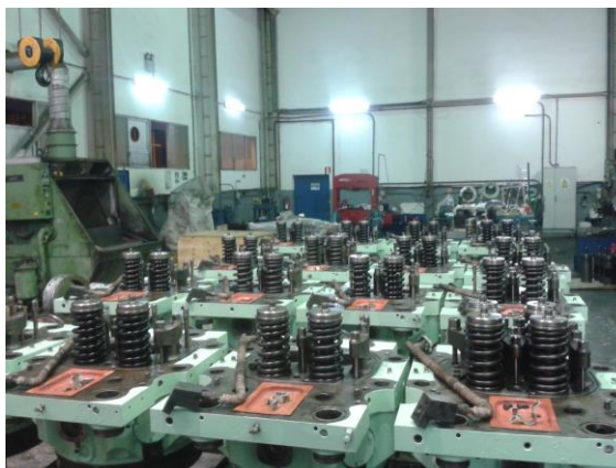
Ilustración 11. Culas preparadas para montaje
