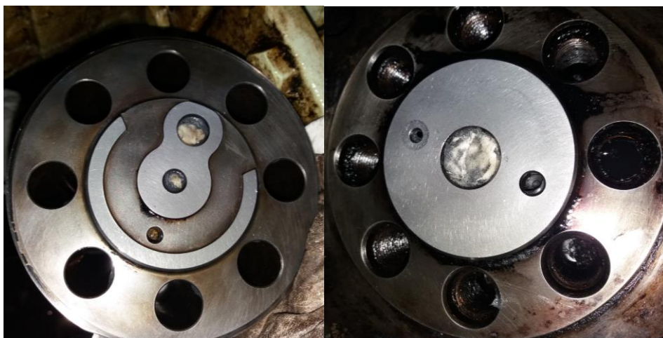
Ilustración 13. Detalle asiento rectificado de cabeza de bomba de inyección
