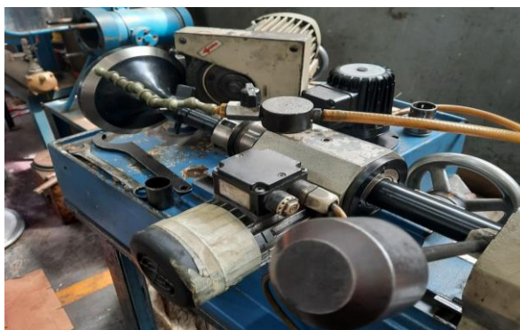
Ilustración 18. Máquina de rectificado de conos de válvula
