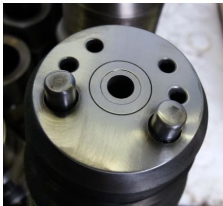
Ilustración 15. Asiento del cuerpo del inyector
