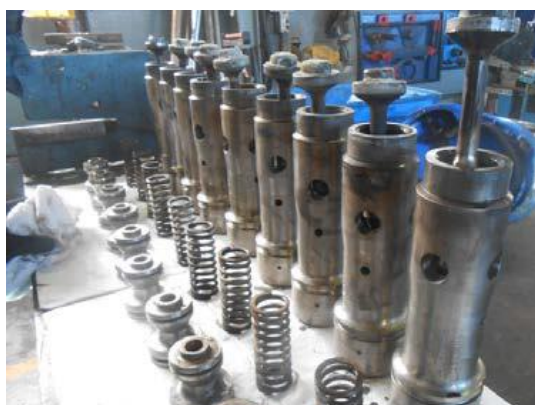
Ilustración 21. Válvulas de arranque desmontadas
