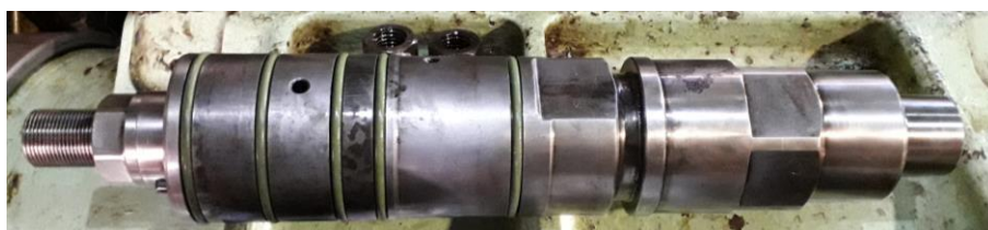
Ilustración 16. Inyector preparado para montaje
