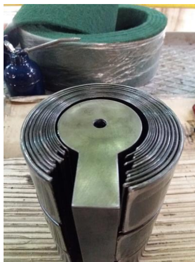
Ilustración 35. Muelle preparado para montaje
