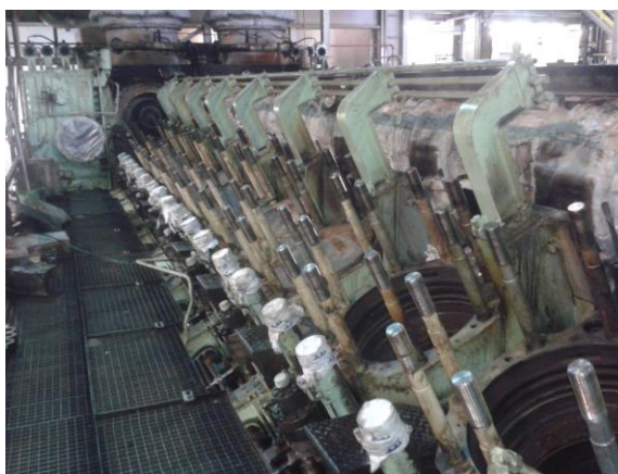
Ilustración 27. Parte alta del bloque, alojamientos de camisas de cilindro
