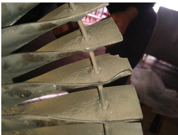
Ilustración 8. Detalle álabes rueda turbina de gases de escape lado B
