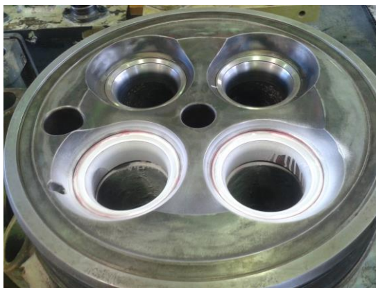
Ilustración 20. Ensayo no destructivo, búsqueda de grietas
