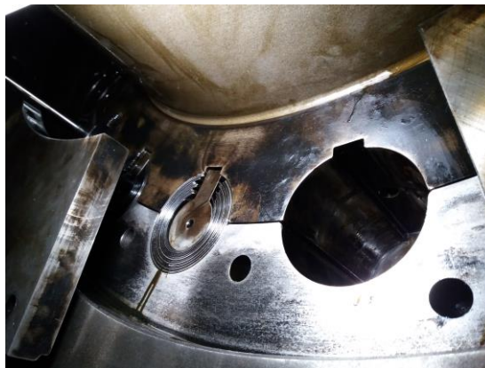
Ilustración 34. Detalle alojamiento del muelle en volante
