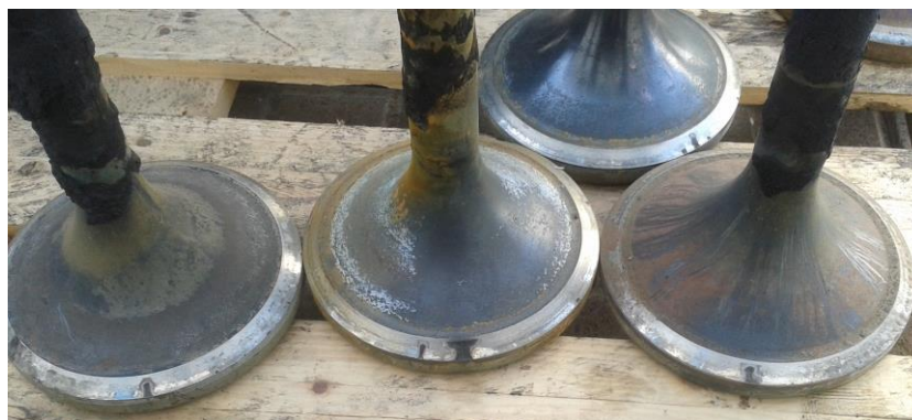
Ilustración 17. Detalle asientos de válvula deteriorados
