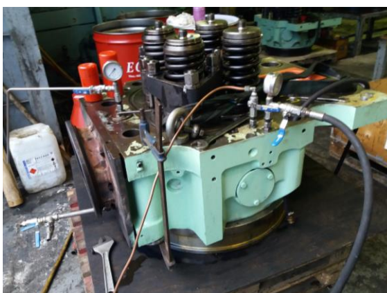
Ilustración 12. Prueba hidráulica culata
