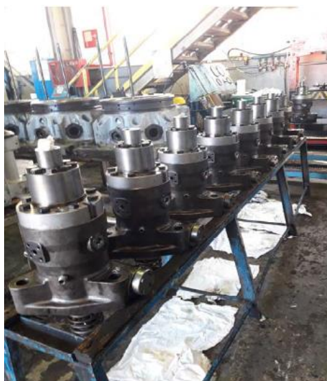
Ilustración 14. Bombas de inyección terminadas
