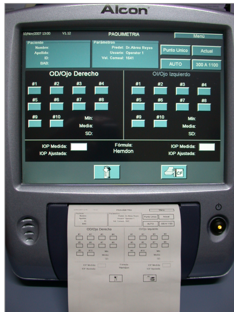
Figura 22: Modelo “dual” Alcon Ocuscan® válido para paquimetría y biometría.
