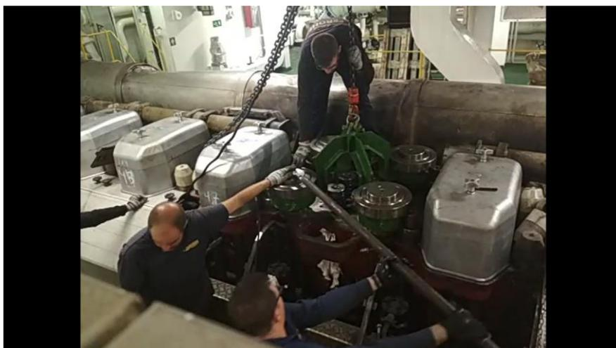
*Figura 46. Colocación de las herramientas hidráulicas (861143). Fuente: Trabajo de campo*
