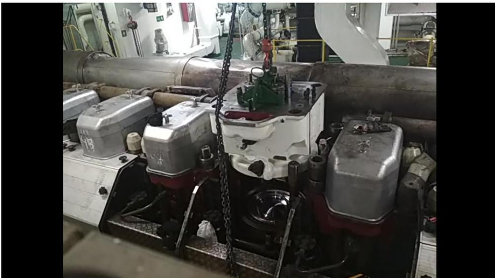
*Figura 64. Colocación de la culata. Fuente: Trabajo de campo*
