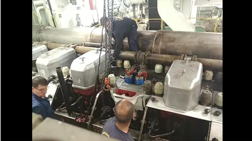
*Figura 68. Montaje de tuberías de agua de refrigeración de alta temperatura (1). Fuente: Trabajo de campo*
