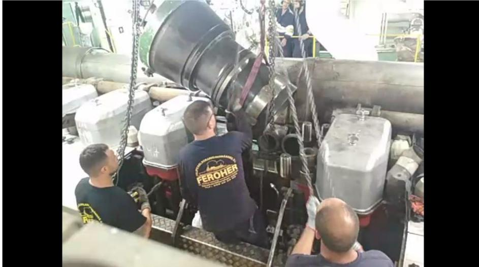
*Figura 56. Montaje de camisa (1). Fuente: Trabajo de campo*
