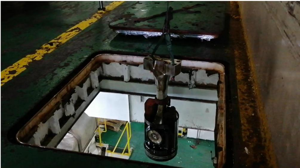
*Figura 53. Retirada de pistón a través de lumbrera. Fuente: Trabajo de campo*
