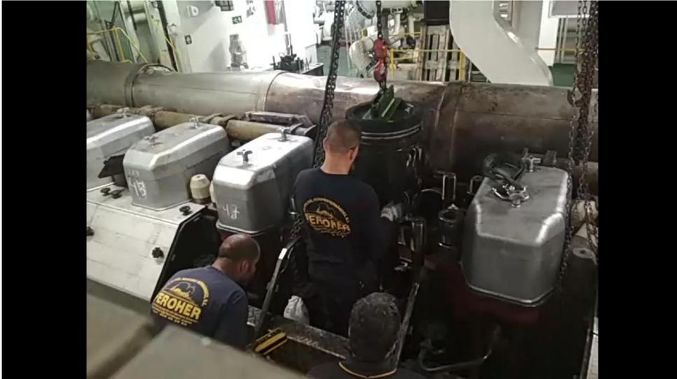
Figura 49. Izado de pistón. Fuente: Trabajo de campo
