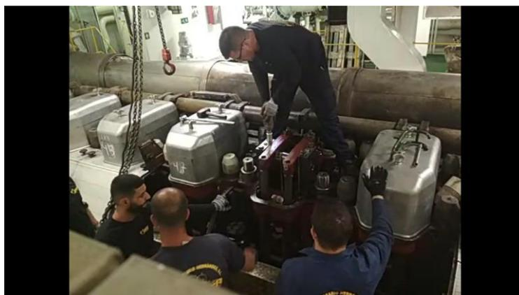
Figura 44. Desmontaje de balancines y empujadores. Fuente: Trabajo de campo
