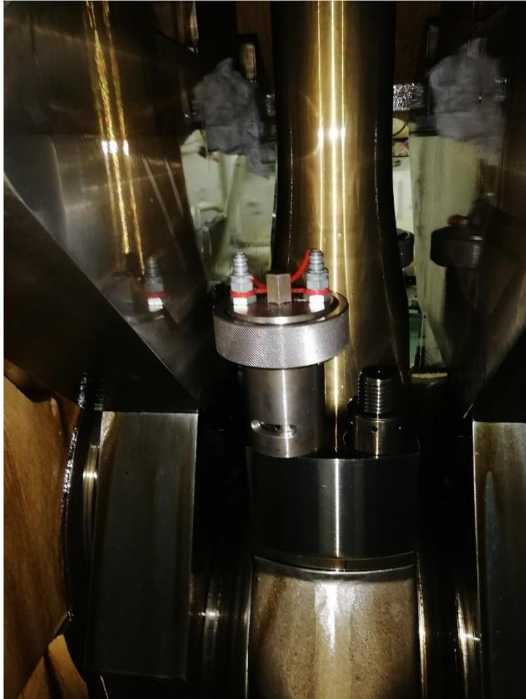
*Figura 48: Colocación de útiles de desmontaje de biela. Fuente: Trabajo de campo*
