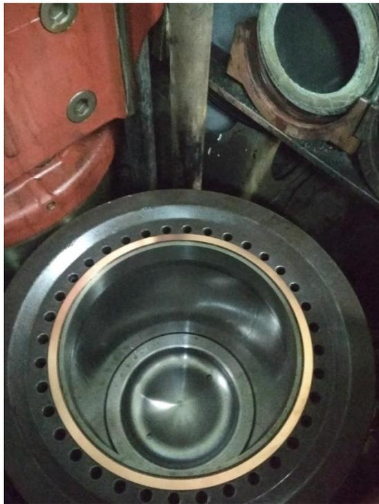
*Figura 63. Pistón montado. Fuente: Trabajo de campo*
