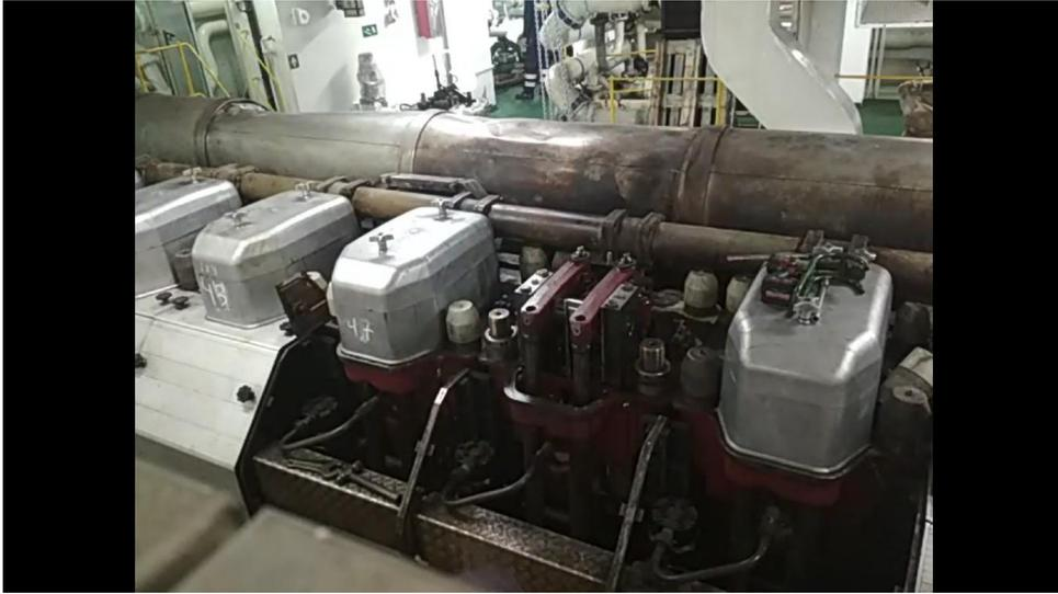
*Figura 42. Desmontaje de tapas caja caliente y tapa de balancines. Fuente: Trabajo de campo*
