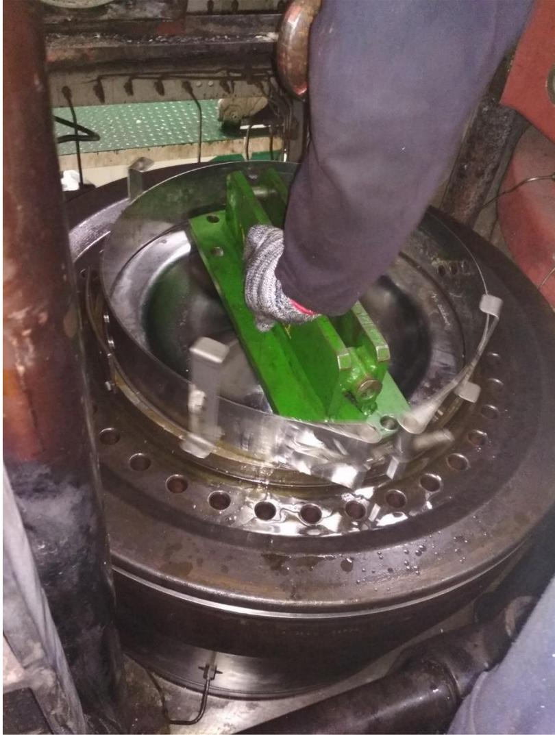
*Figura 59. Montaje de pistón (1). Fuente: Trabajo de campo*
