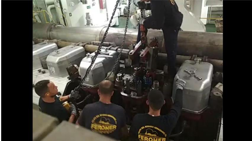
*Figura 45. Desmontaje de balancines y empujadores (1). Fuente: Trabajo de campo*
