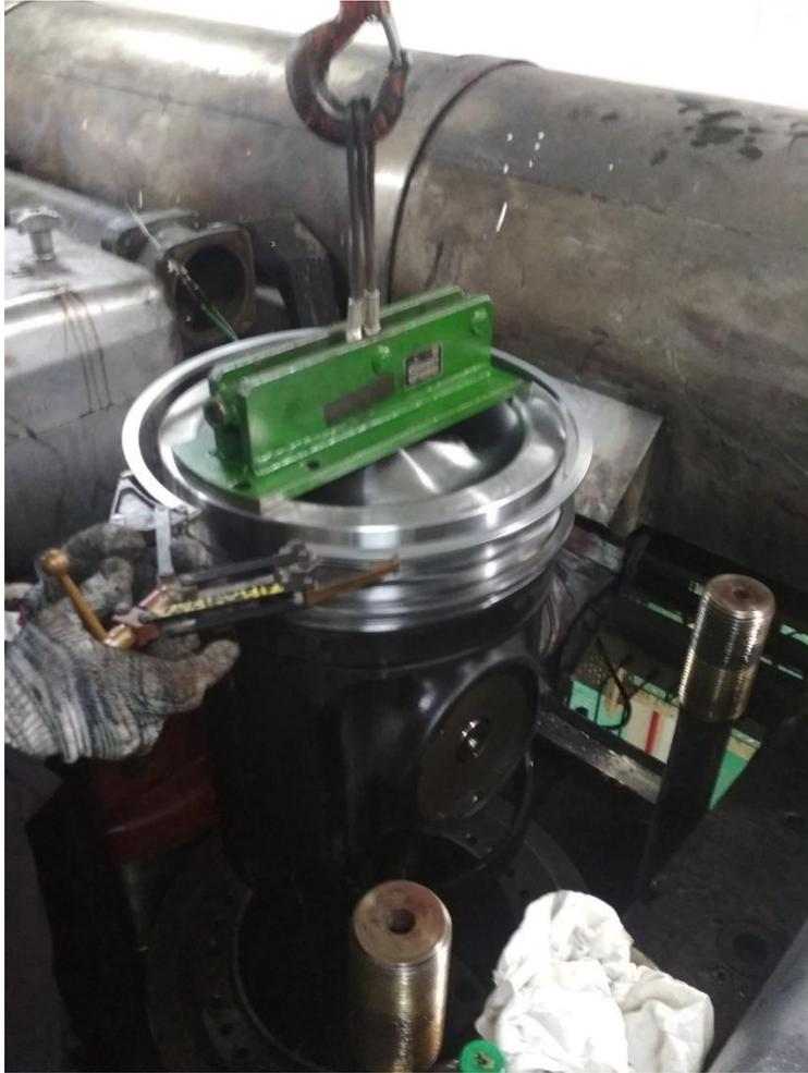
*Figura 57. Montaje aros de pistón. Fuente: Trabajo de campo*
