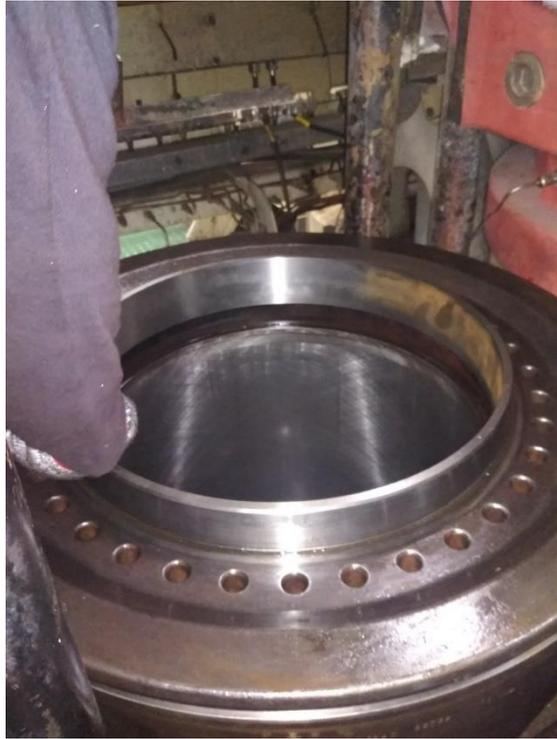
*Figura 62. colocación aro antidesgaste. Fuente: Trabajo de campo*
