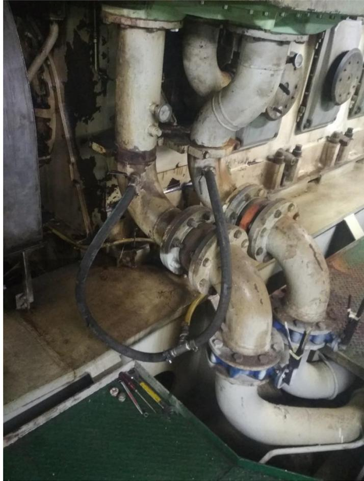
*Figura 41. Conexiones para vaciado de agua de refrigeración de motor principal. Fuente: Trabajo de campo*
