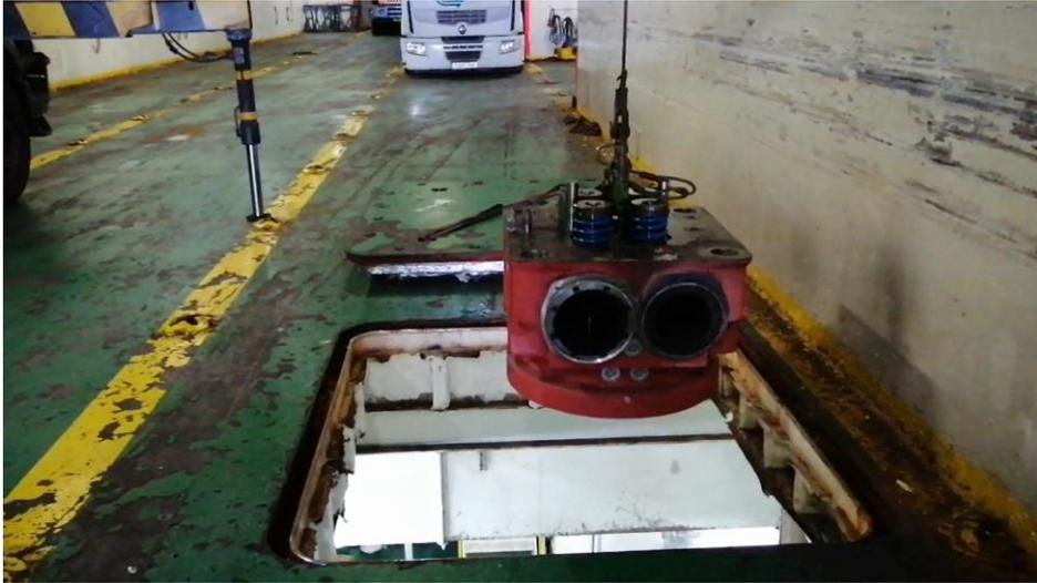
*Figura 52. Retirada de culata a través de lumbrera. Fuente: Trabajo de campo*
