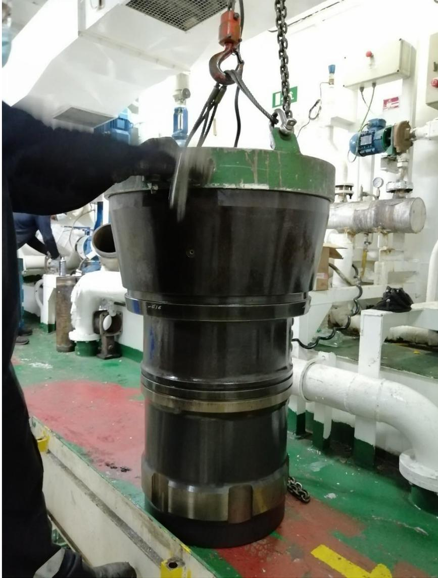
*Figura 55. Montaje de camisa. Fuente: Trabajo de campo*
