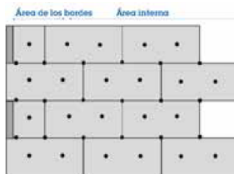
Figura 6. Colocación de espigas para placas de EPS de 100x600mm.
