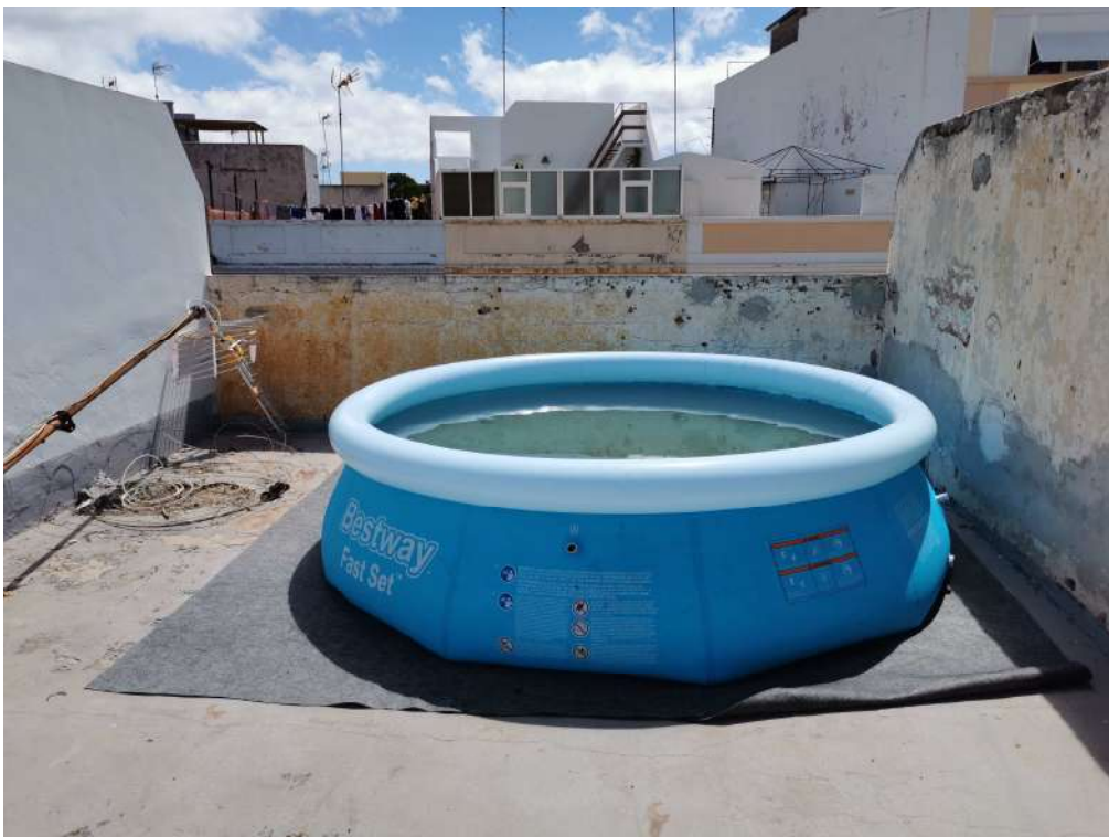
Carga colocada Prueba N° 01
