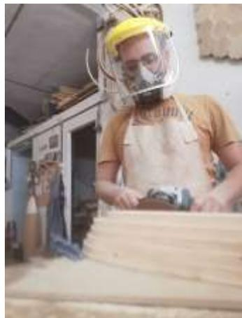
*Fig. 74 Trabajo con radial equipada con un disco abrasivo.*
