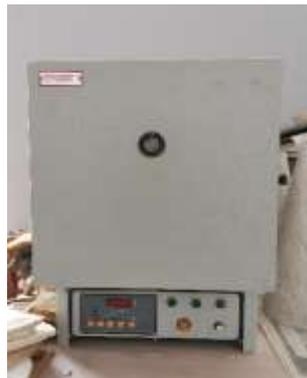
Fig. 29 Horno eléctrico de pruebas.
