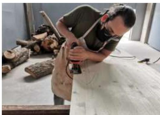
*Fig. 38 Corte de la madera con una caladora.*
