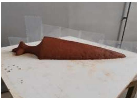
Fig. 24 Pieza con barrera para hacer un molde compuesto.
