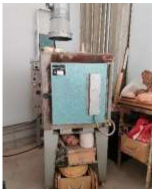
Fig. 49 Horno eléctrico de bizcochados.
