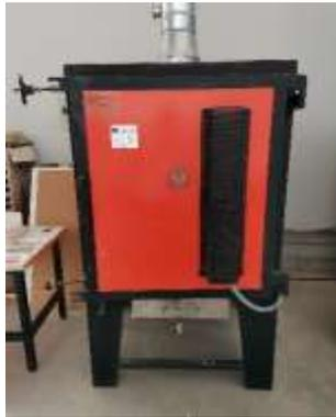
Fig. 51 Horno eléctrico de cocción definitiva.
