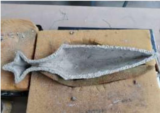
*Fig. 26 Primer paso del cosido en la pieza.*
