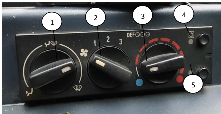
Figura 46. Interruptores del sistema de climatización [11].
