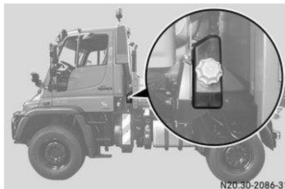
Figura 86. Depósito de líquido refrigerante [1].
