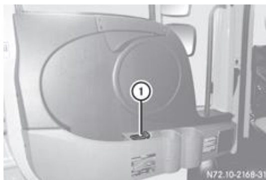
Figura 29. Interruptor de bloqueo desde el interior de la cabina [1].
