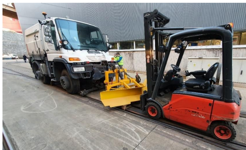
Figura 77. Instalación de la pala quita lodo [11].
