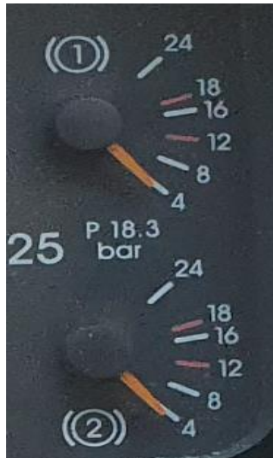
Figura 50. Indicadores de presión del circuito de frenos [11].
