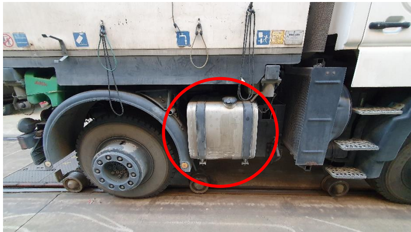
Figura 67. Depósito de combustible [11].
