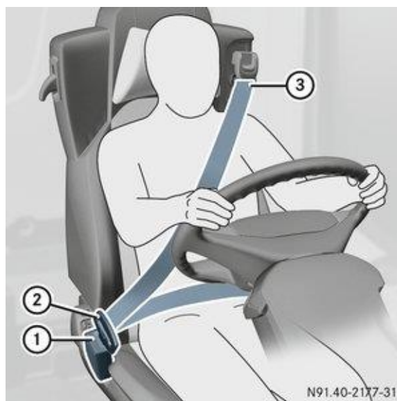
Figura 32. Colocación del cinturón de seguridad [1].
