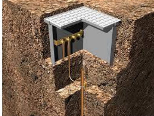
Figura 2.12 Instalación de Tierra con una pica.
