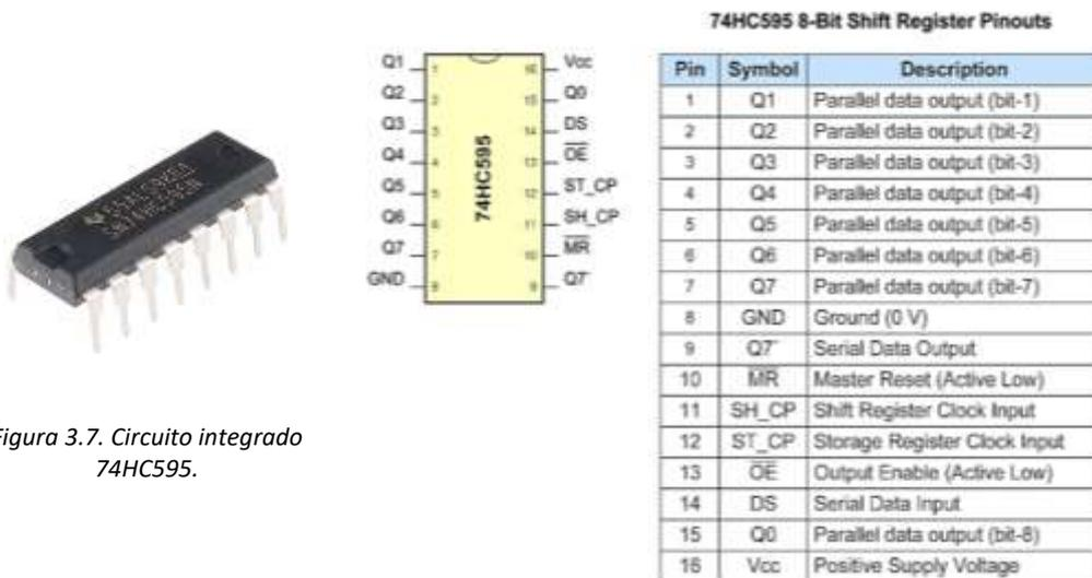
Figura 3.7. Circuito integrado 74HC595.
