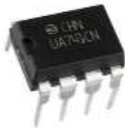
Figura 2.10. Amplificador Operacional  $\mu A741$ .
