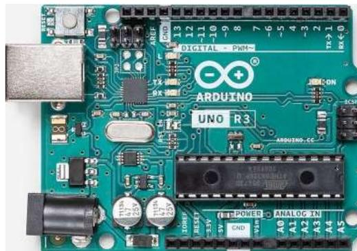
Figura 3.6. Microcontrolador Arduino Uno.
