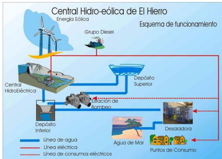
Ilustración 1. Esquema de funcionamiento de la Gorona del Viento (isla de El Hierro).
