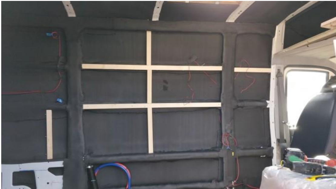
Figura 69. Ejemplo de colocación rastrelado. Fuente: furgonetaypunto.wordpress.com
