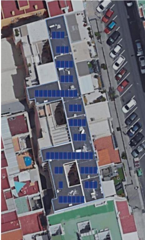
Dando como resultado una planta de 60 módulos, con una potencia de 33kW.
