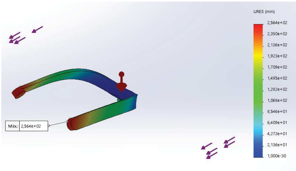
Imagen [100] Prueba estática 2 de desplazamiento de Guía Raíl del prototipo 5 en ABS; Fuente: Propia
