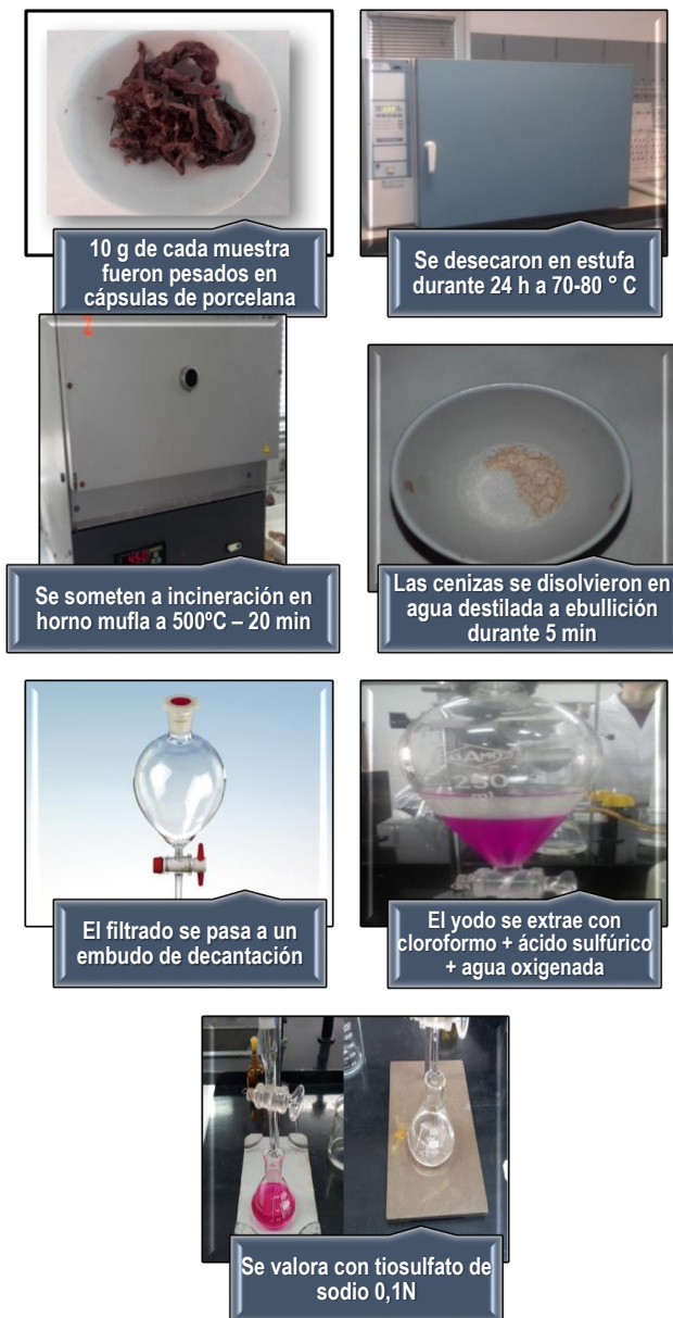
Figura 26. Esquema del procedimiento de determinación de yodo
