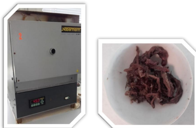
Figura 22. Foto del horno mufla usado para la incineración de las muestras (izquierda) y muestra de alga Asparagopsis en cápsula de porcelana (derecha)
