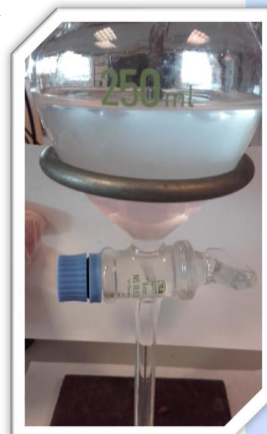
Figura 25. Extracción del yodo en disolución
