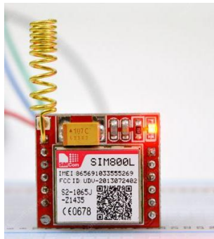
Figura 3.9. Módulo SIM800L empleado para las comunicaciones del sistema.
