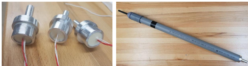
Figura 2.8. (a) Configuración final de las puntas de aluminio junto con los sensores PT100 y (b) Configuración final de los termómetros
