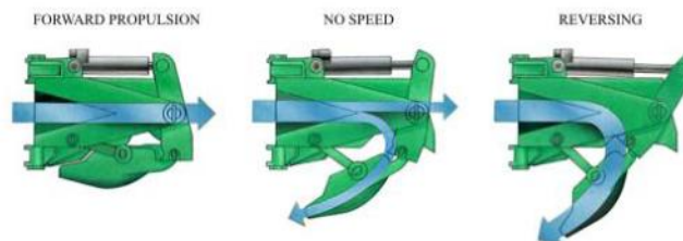
Figura 14: Descripción gráfica conducción del chorro por medio de buckets
