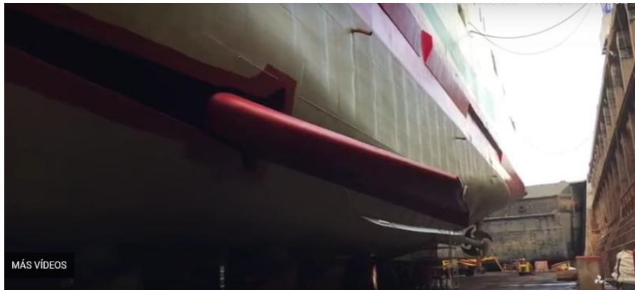
Figura 22: Estabilizadores de buques convencionales “Active Fins”.
