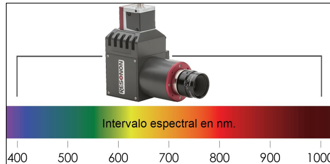
Figura 4.3 Cámara hiperespectral Resonon Pika L (Resonon, 2020).
