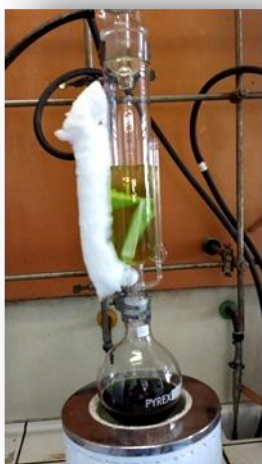
Figura 3.3. Extracción de H. canariense realizada con el método Soxhlet.
