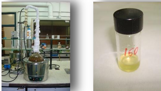
Figura 3.4. (a, izquierda) equipo Clevenger extrayendo a H. grandifolium ; (b, derecha) vial de cierre hermético utilizado para la conservación de los aceites esenciales tras su obtención por hidrodestilación; ejemplo de H. reflexum de Ifonche.
