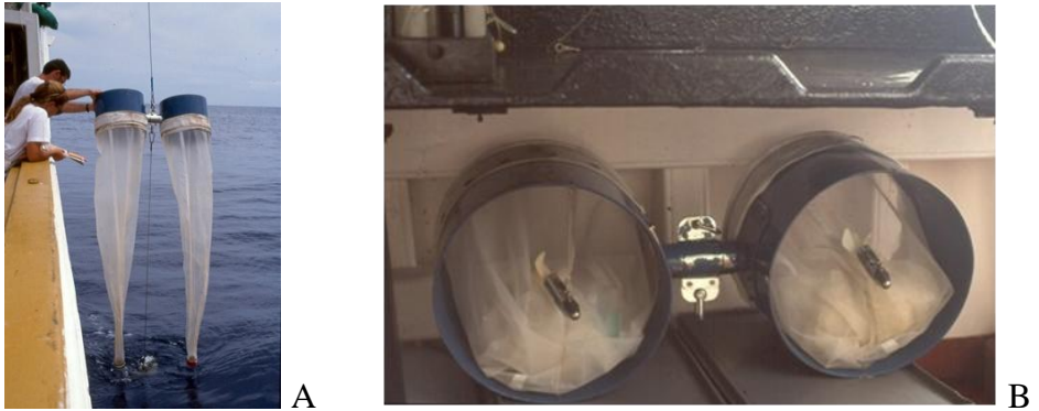
Figura 4.2.- A.- Red Bongo. B.- Detalle de embocaduras con flujómetros
