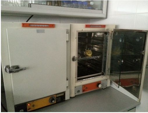
Foto MM19. Estufa en la se mantenían las muestras del lóbulo superior del pulmón izquierdo durante 72 horas a 50°C para obtener la relación peso húmedo/peso seco (índice wet/dry ).
