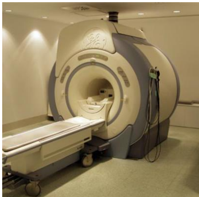
Figura 2.2. Escáner de resonancia magnética de 3.0 T de la Universidad de La Laguna, fabricado por General Electric.
