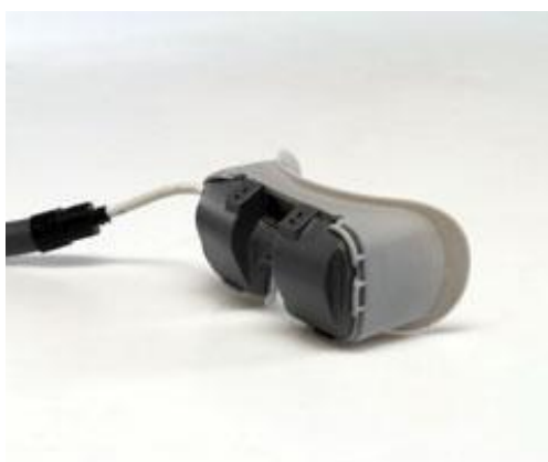
Figura 2.6. Gafas compatibles con resonancia magnética para la presentación de estímulos visuales.
