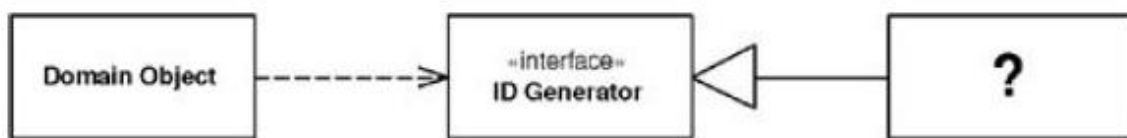
Figura 3.1. Diagrama de clases del patrón Plug-in
