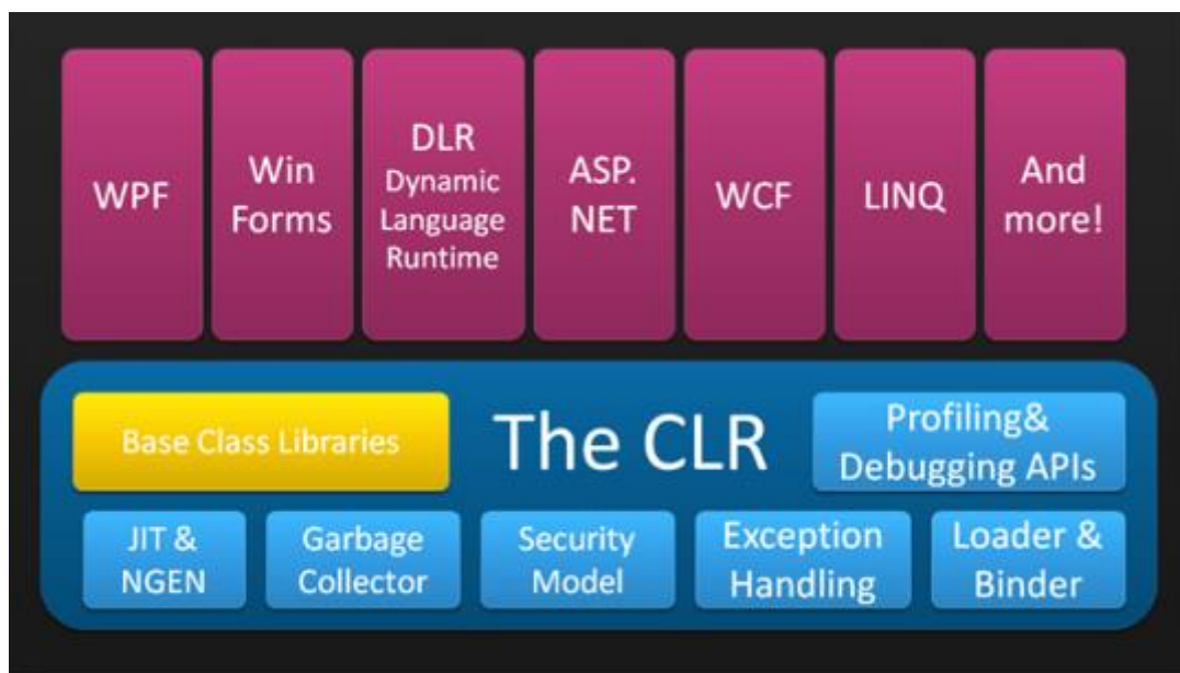
Figura 5.3. CLR y sus principales componentes.
