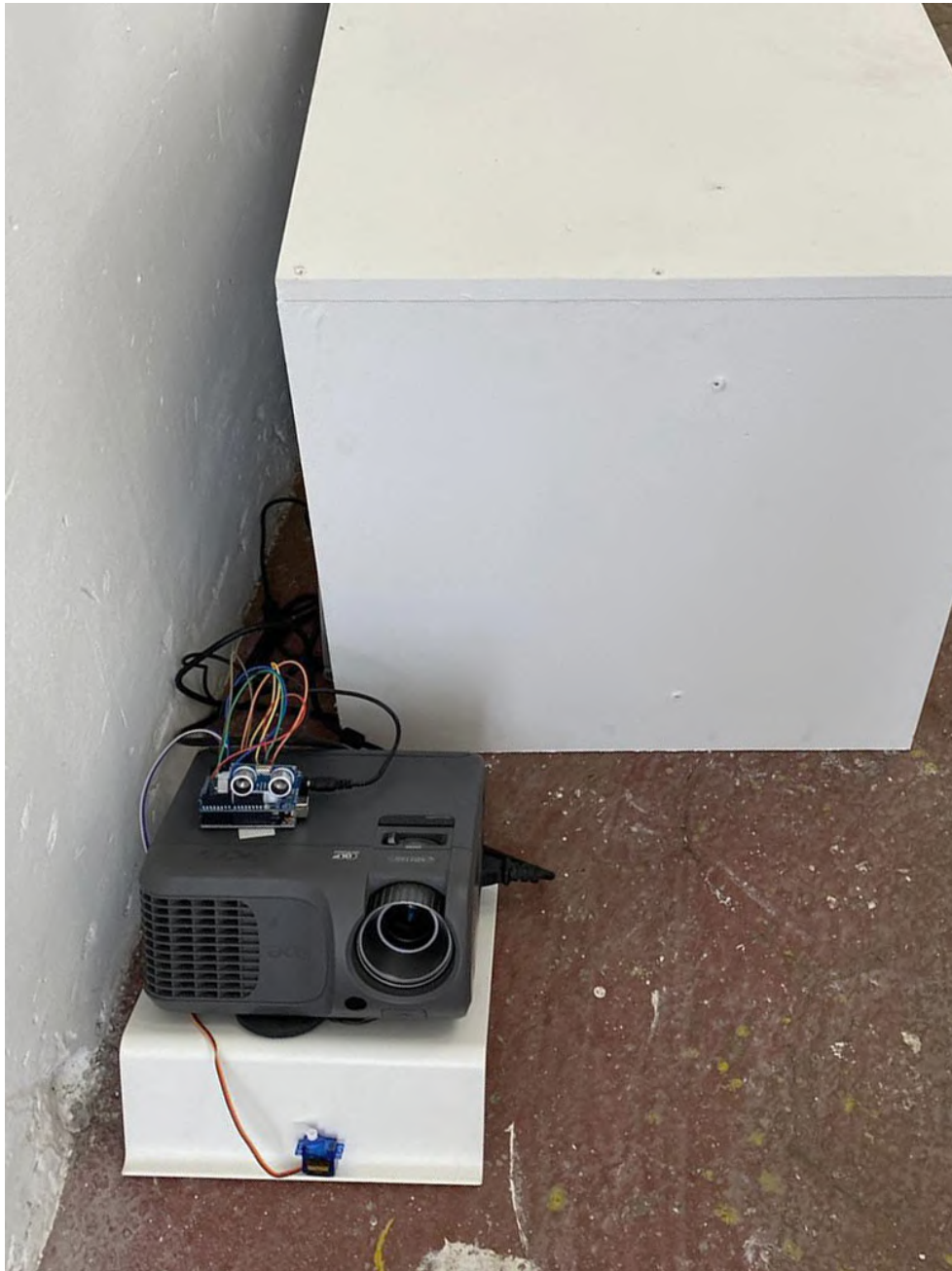
fig.88 Arduino y sensor montados sobre el proyector de normas.
