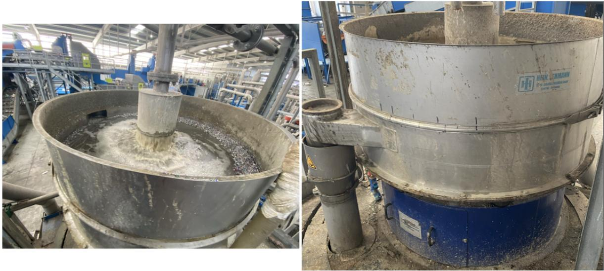
*Ilustración 22. Criba vibradora. Fuente: trabajo de campo.*
