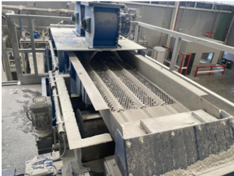
*Ilustración 35. Criba vibradora. Fuente: trabajo de campo.*
