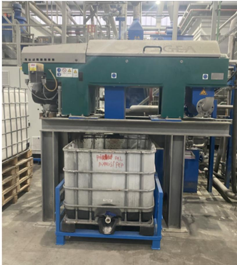
*Ilustración 26. Decantador centrífugo. Fuente: trabajo de campo.*
