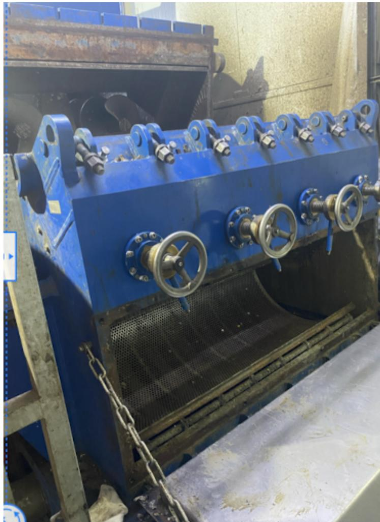
*Ilustración 17. Molino. Fuente: trabajo de campo.*
