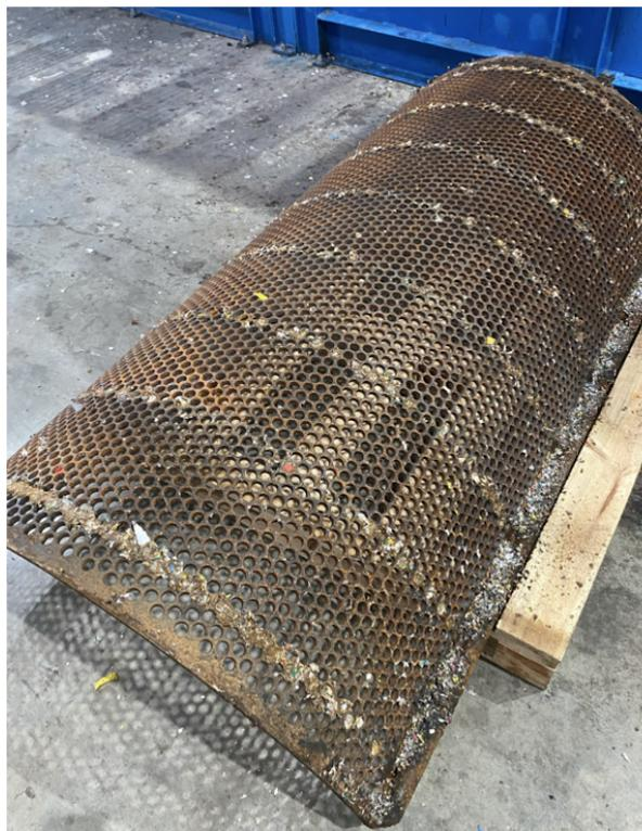
**Ilustración 16.** Criba. Fuente: trabajo de campo.
