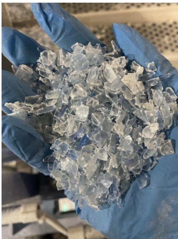
*Ilustración 39. Copos PET listo para ensacar. Fuente: trabajo de campo.*
