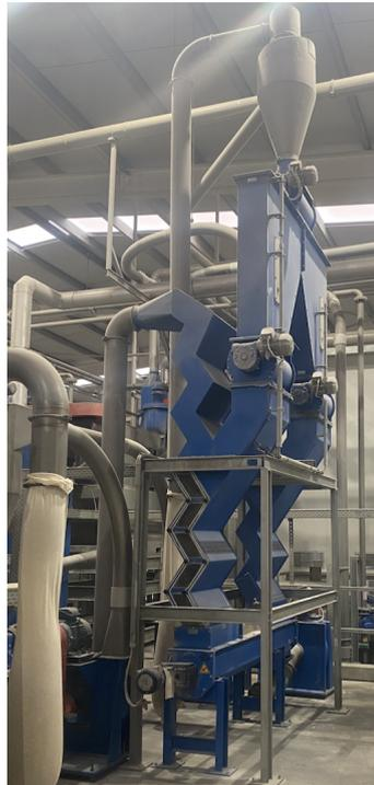
**Ilustración 18.** Separador aerodinámico. Fuente: trabajo de campo.
