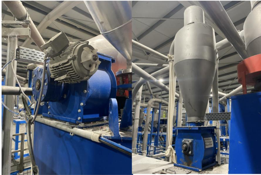
*Ilustración 33. Rotoválvula y ciclón. Fuente: trabajo de campo.*
