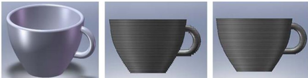
Figura 6.17. Efectos de los distintos espesores de capa en una taza de té [52].
