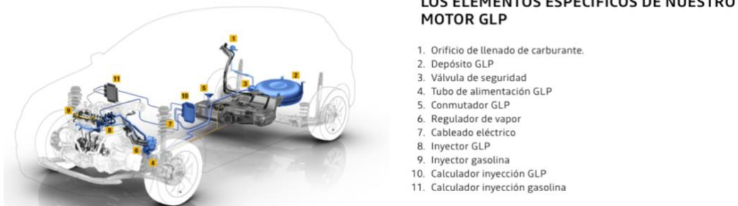
Figura 2.11. Elementos de un motor GLP.
