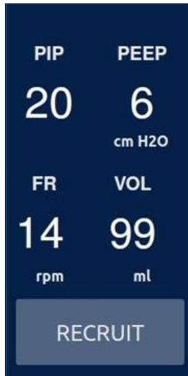
Al iniciar Reespirator 23 se muestran los valores de funcionamiento en tiempo real. Estos parámetros de funcionamiento, que se detallan a continuación, se refrescan cada 100 milisegundos:
