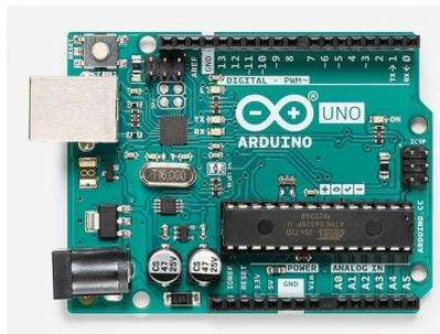
Arduino UNO. Figura 5. Fuente: Arduino.cc
