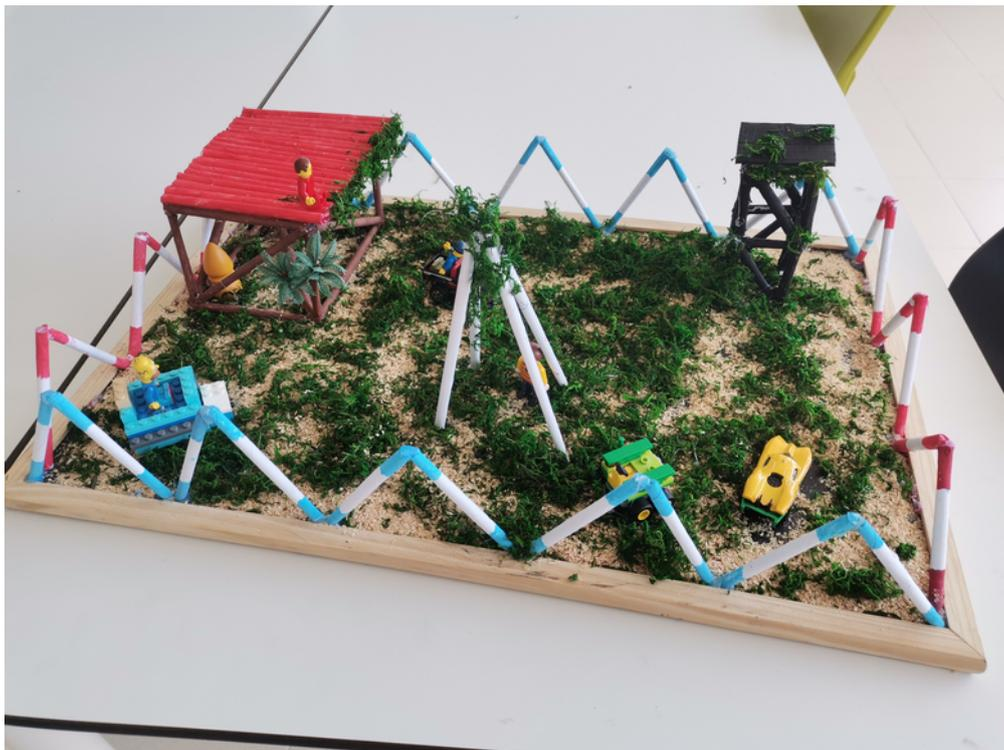
Las fotos del resultado final se hicieron después de realizar la prueba de soporte de 2kg de peso. Tanto el Grupo 3 como el 4 tuvieron problemas de resistencias en la estructura. La maqueta del Grupo 3 quedó completamente destruida. La del Grupo 4 se muestra a continuación.
