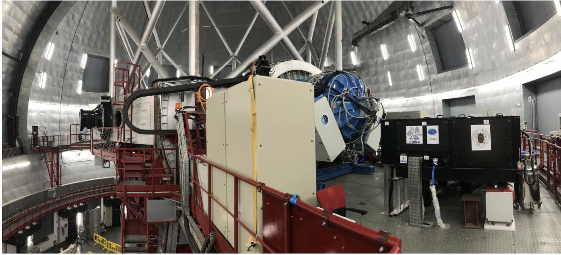
Figura 5: Imagen de los componentes de MEGARA compartiendo el foco con el espectrógrafo EMIR en la plataforma Naysmith A del GTC
