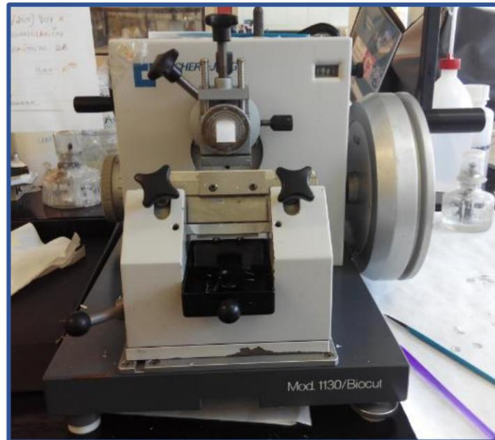
Fotografía 16.- Micrótopo Reichert-jung Mod. 1130/Biocut.
