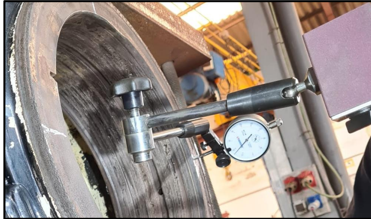
Ilustración 73: Reloj comparador. Fuente: Foto cedida al autor.
