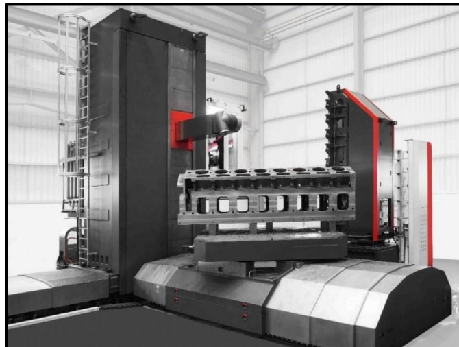
Ilustración 6: Mandrinadora hidrostática de columna móvil actual. Fuente: [17]
