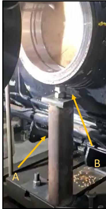
Ilustración 71: Detalle apoyo del alojamiento. Fuente: Foto cedida al autor.
