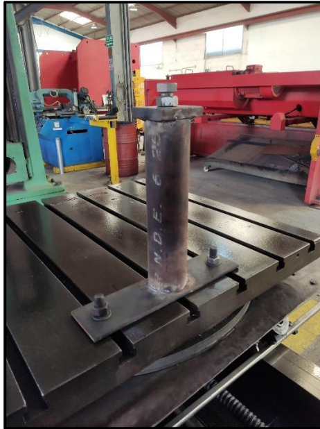
Ilustración 56: Ejemplo de útil de fijación sobre la mesa. Fuente: Trabajo de campo.
