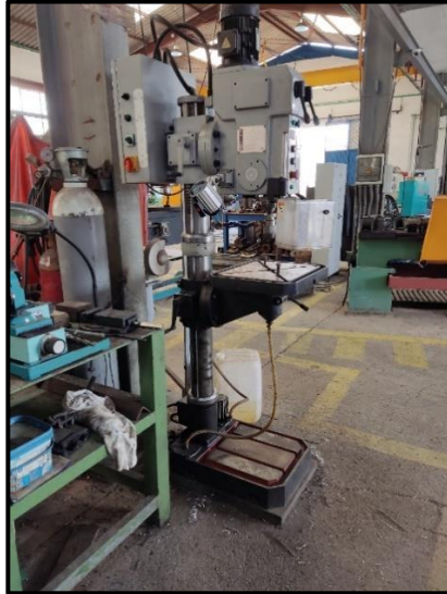
Ilustración 24: Taladro columna. Fuente: Trabajo de campo.
