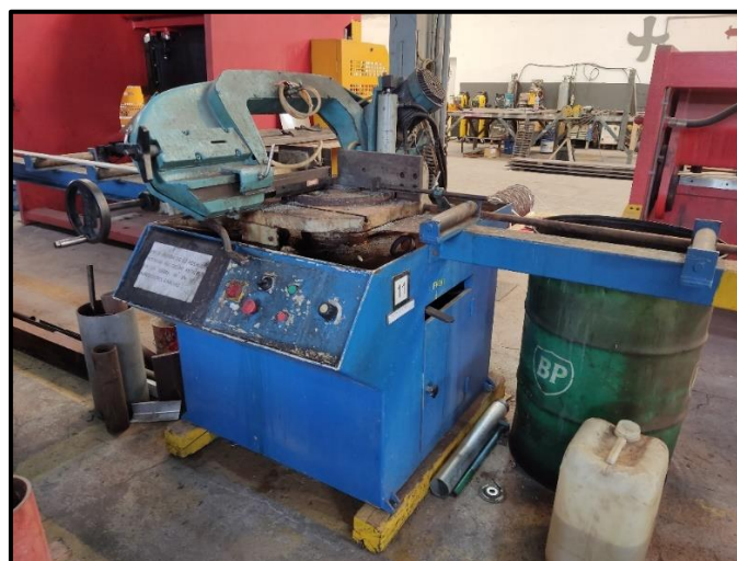
Ilustración 23: Sierra de cinta. Fuente: Trabajo de campo.
