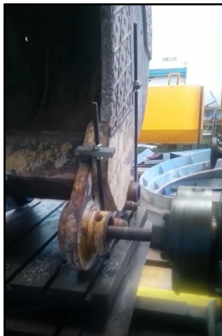
Ilustración 65: Cuchara de excavadora en mandrinadora. Fuente: Foto cedida al autor.
