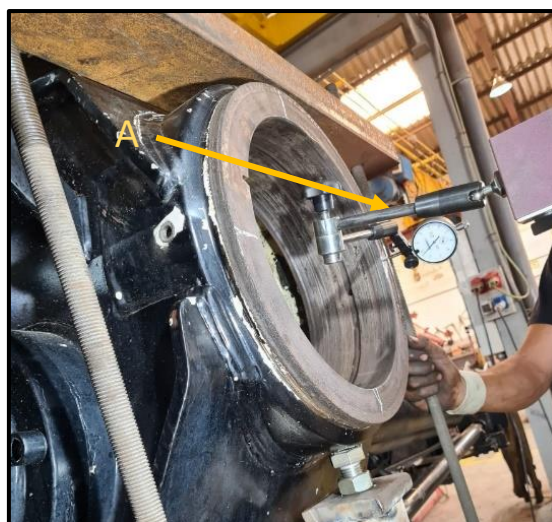
Ilustración 69: Alojamiento del brazo principal de una grúa comprobando el centrado sobre la mandrinadora. A- Reloj comparador. Fuente: Foto cedida al autor.
