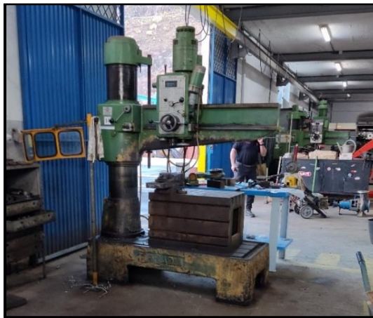
Ilustración 31: Taladro columna. Fuente: Trabajo de campo.
