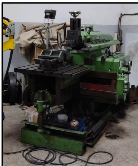
Ilustración 32: Cepillo limadora para realizar chavetero. Fuente: Trabajo de campo.
