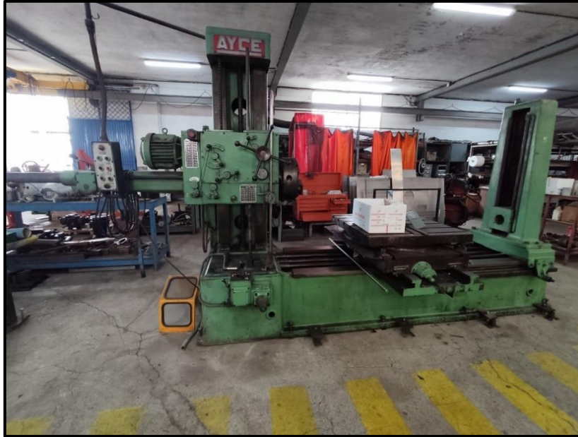
Ilustración 38: Mandrinadora. Fuente: Trabajo de campo.
