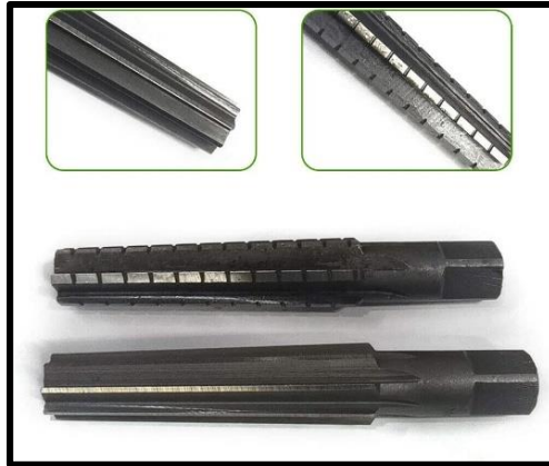
Ilustración 19: Escariador cónico de desbaste (arriba) y escariador cónico de acabado (abajo). Fuente: [32]
