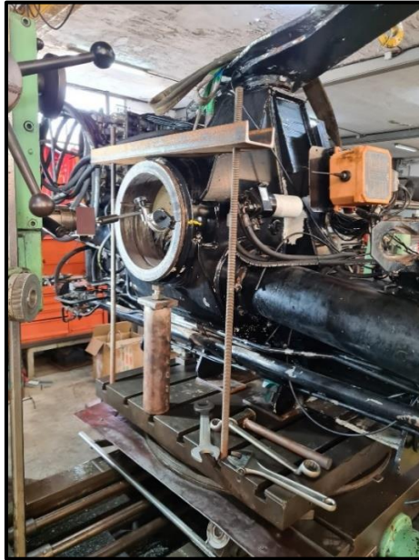
Ilustración 68: Alojamiento brazo principal grúa con los útiles ya instalados. Fuente: Foto cedida al autor.
