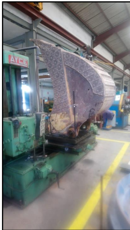
Ilustración 61: Cuchara de excavadora. Fuente: Foto cedida al autor.
