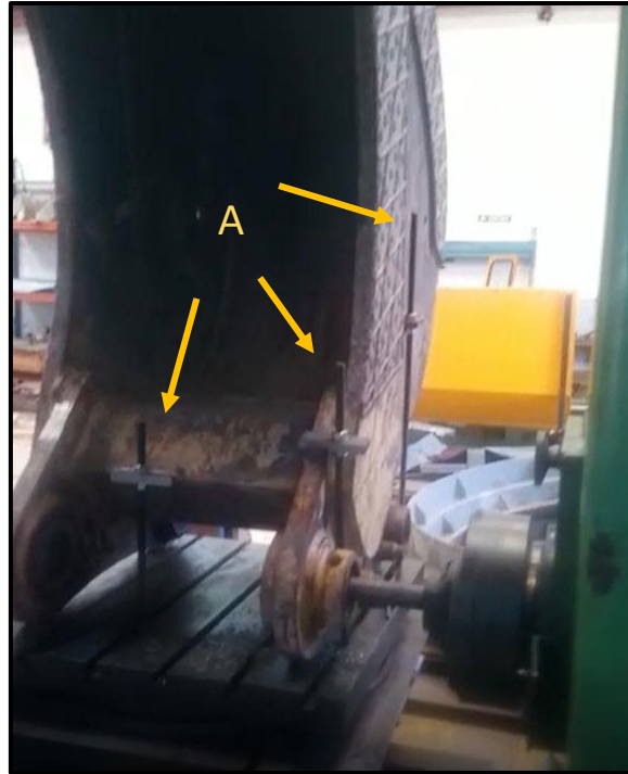
Ilustración 64: Fijación de la cuchara. Fuente: Cedida al autor.
