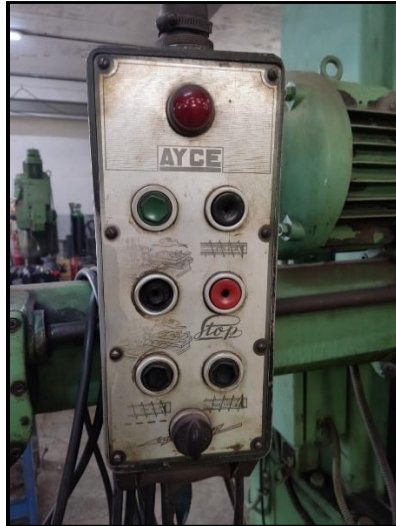
Ilustración 44: Control de mandrinadora. Fuente: Trabajo de campo.
