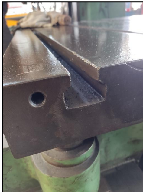
Ilustración 55: Ranura fijación de la mesa. Fuente: Trabajo de campo.
