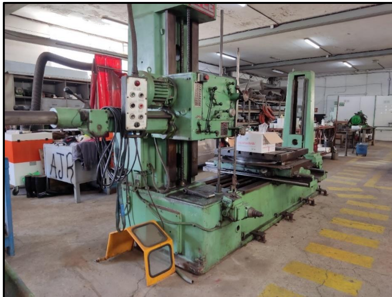
Ilustración 39: Mandrinadora. Fuente: Trabajo de campo.
