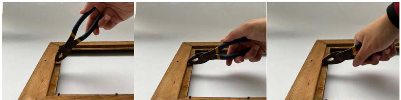
Fig. 4.5. Eliminación de las grapas de sujeción con alicate. 1º. Se aplica presión para levantarlas y realizar el desmontaje. 2º. Se coge la grapa con el alicate. 3º. Se dobla hacia abajo (ya que para el desmontaje se tuvo que doblar hacia arriba). 4º. Se ejerce presión y se retira.
