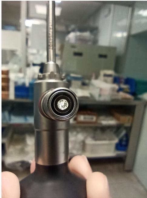
*Figura 6a. Fotografía tomada con el móvil de la zona que contiene las fibras ópticas del Endoscopio*
