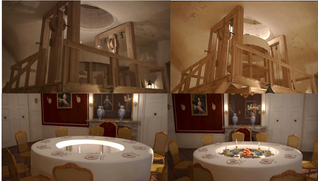
Fig. 45- Secuencia de funcionamiento de la table volante . Arriba: Sistema de poleas en las cocinas del sótano, Abajo: Servicio en la mesa del comedor.
