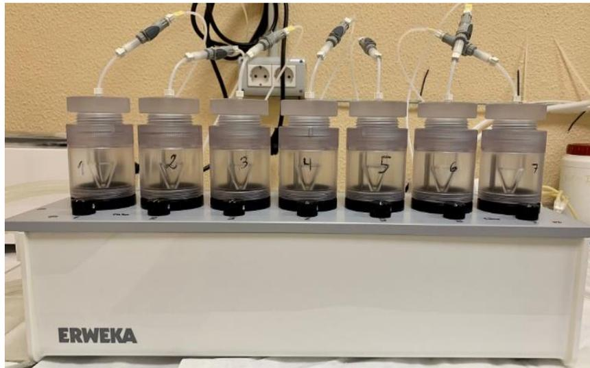
*Figura 3. Baño termostatzado compuesto por 7 celdas.*
