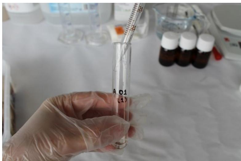
Fig. 13 Adición de reactivo a la muestra con una pipeta
