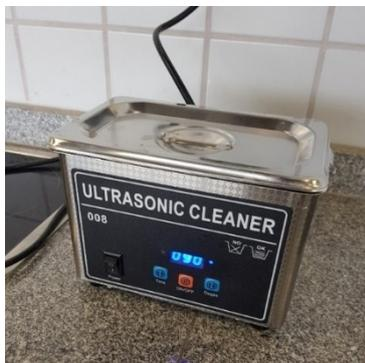
Fig. 19 Limpiador de ultrasonidos en funcionamiento
