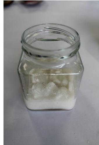
*Fig. 27 Pasta recogida con agua destilada para hacer la medición*
