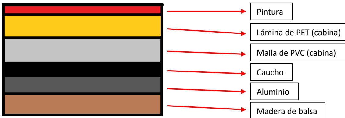
Fig. 20: Esquema correspondiente a la división por estratos de la pieza (encontrándose abajo el soporte de madera, hasta la capa de pintura, suprayacente a todas las demás).
