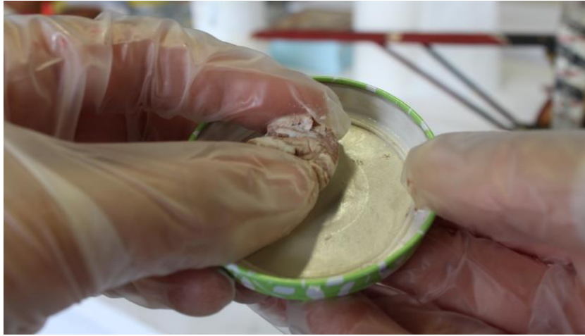
Fig. 170: Masilla epóxica Axson® durante el amasado, antes de su utilización.
