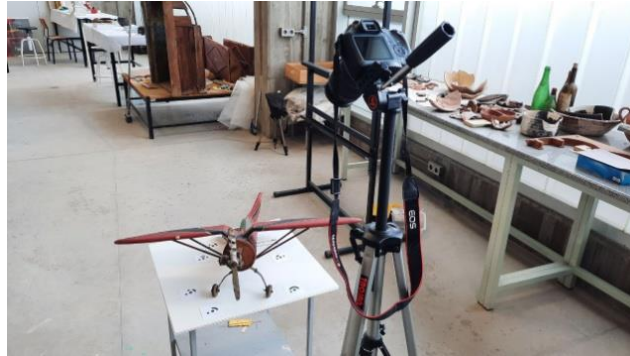
Fig. 56 y Fig. 57: Condiciones de toma de las fotografías, en el taller. Se mantuvo la cámara fija y se fue rotando el objeto, ya que resultaba más sencillo.
