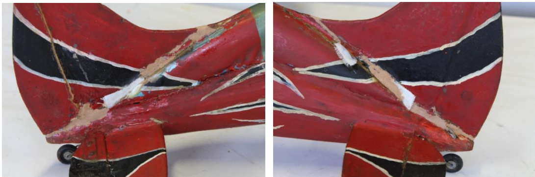
Fig. 184 y Fig. 185: Aspecto de las lagunas estructurales en la zona del alerón, tras haber sido rellenadas con masilla Axson®, por ambos laterales.
