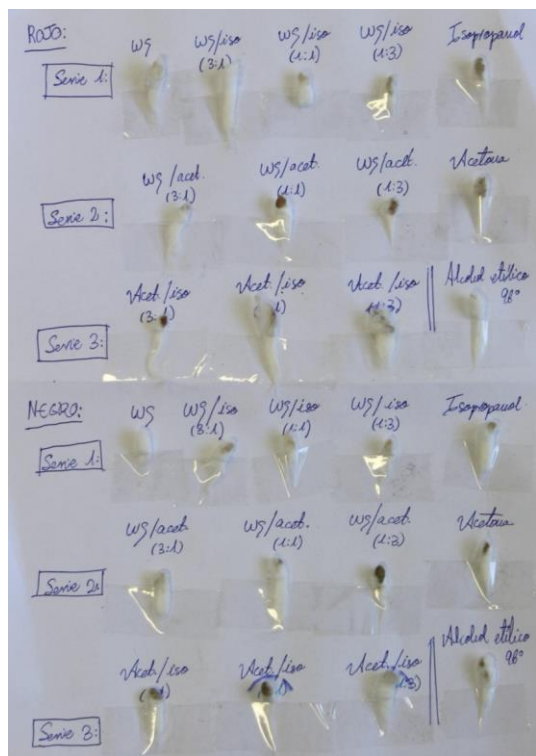
Fig. 147: Hisopos utilizados para probar cada mezcla de disolventes, que sirven como testigos del grado de eficacia de cada una.
