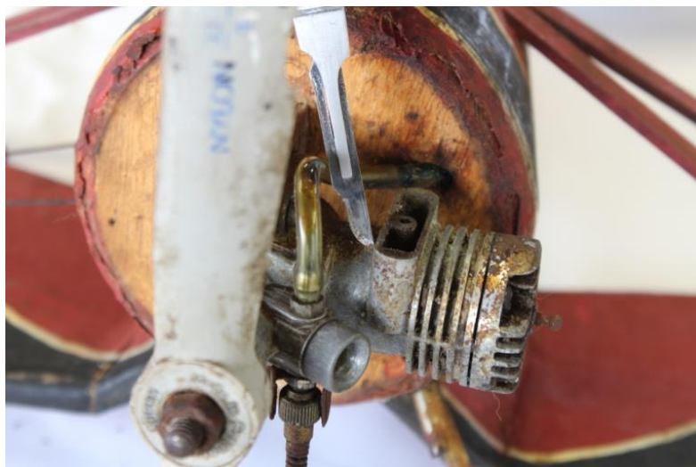
Fig. 154: Eliminación de suciedad superficial del motor, con un bisturí.
