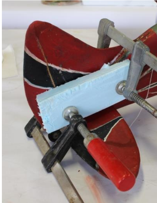
Fig. 183: Sistema de sujeción empleado para el secado correcto del alerón.
