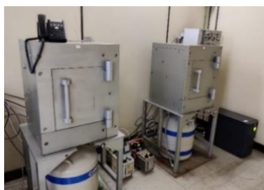
Figura 4. Detectores de Germanio intrínseco de alta pureza (GeHP) Canberra GR2520.
