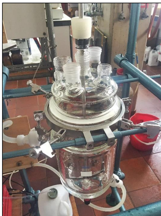
Figura 4.3. Biodigestor con control continuo de pH
