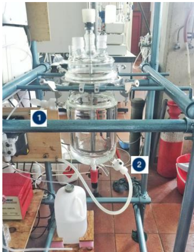
Figura 4.8. Sistema de calefacción con agua en el reactor
