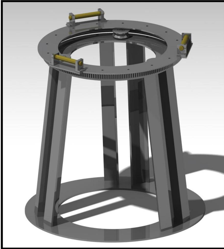
Figura 43 – Renderizado de un posible diseño del sistema de rotación (contemplando solo la estructura básica) con la base del sistema 3DoF.
