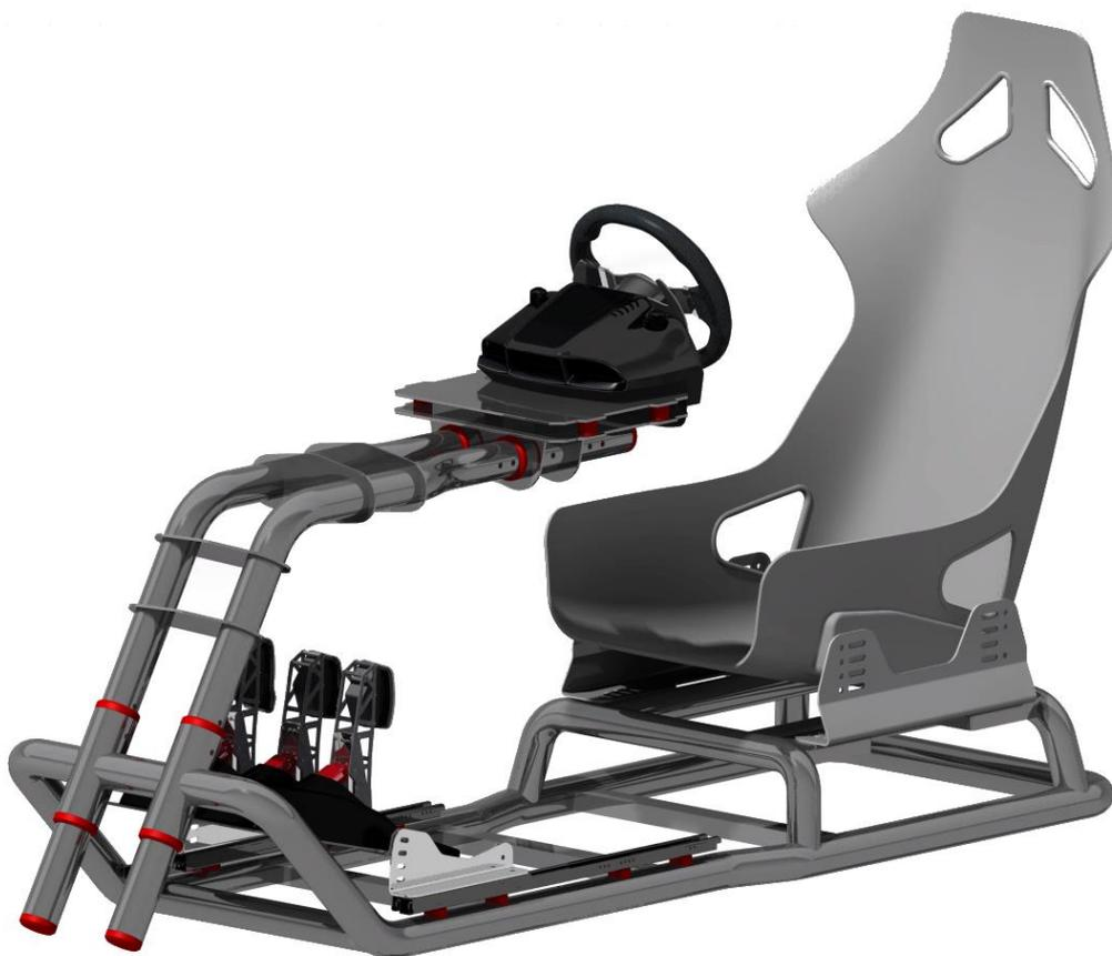
Figura 53 – Renderizado de la segunda propuesta para el puesto de conducción.
