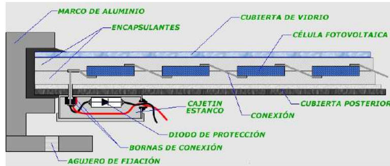
Figura 3.8: Elementos módulo fotovoltaico [14].
