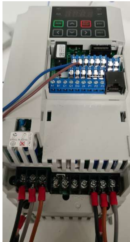
Figura 8.3: Variador de frecuencia S100.
