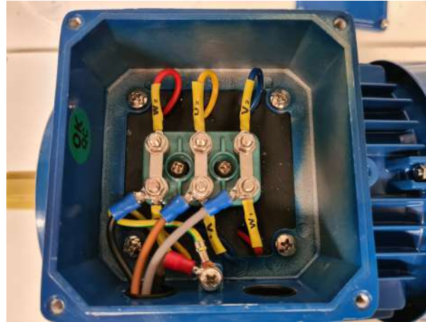
Figura 4.7: Conexión triángulo motor [15].
