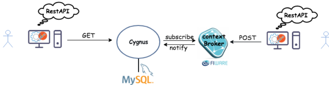
Figura 4.11: Funcionamiento habilitador Cygnus
